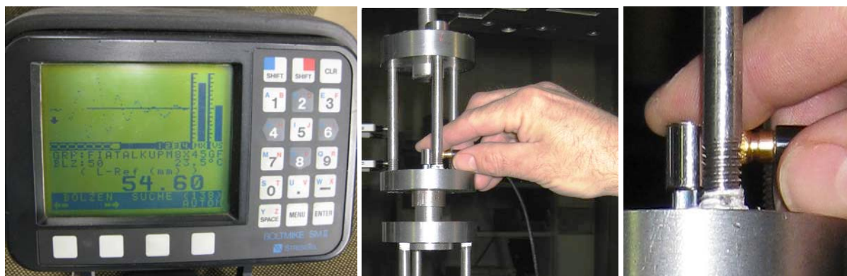
Abb. 3.1: BoltMikeII (a); Messung der Vorspannkraft mit Prüfkopf (b); im Detail (c)
