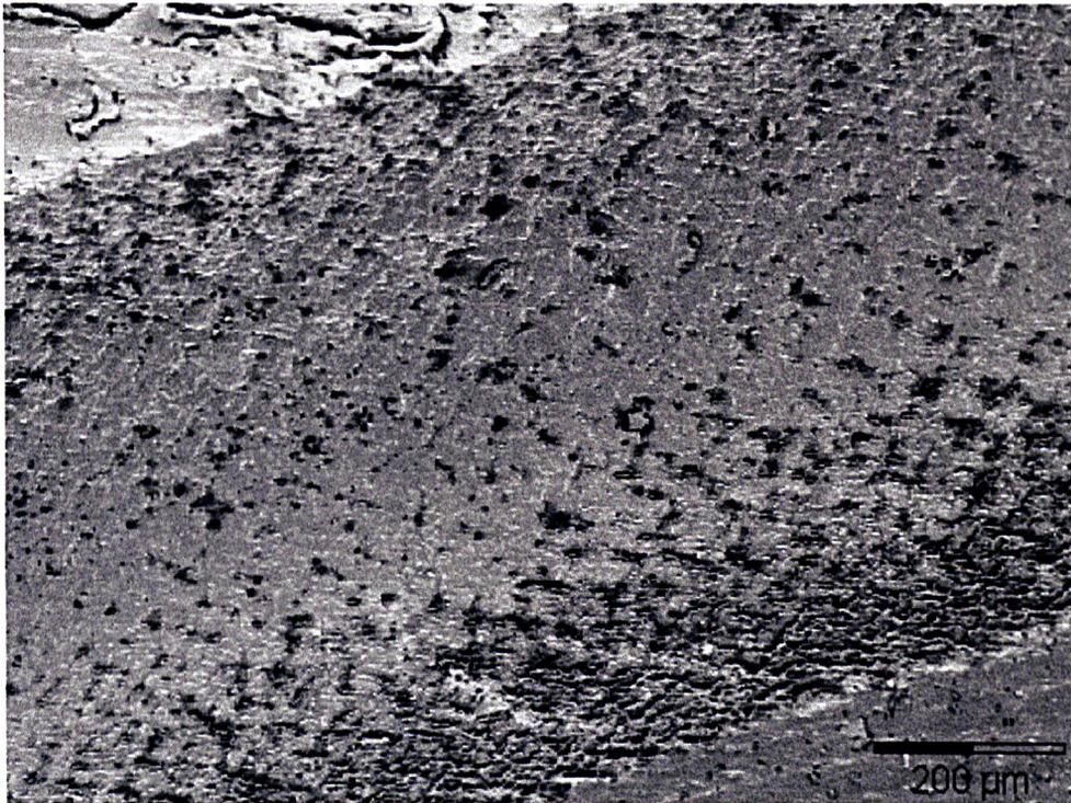
Abb. 6.21: Innenfläche eines Tygon®-Schlauches. Raue Innenfläche durch Extraktion von Weichmacher, 100-fache Vergrößerung.
