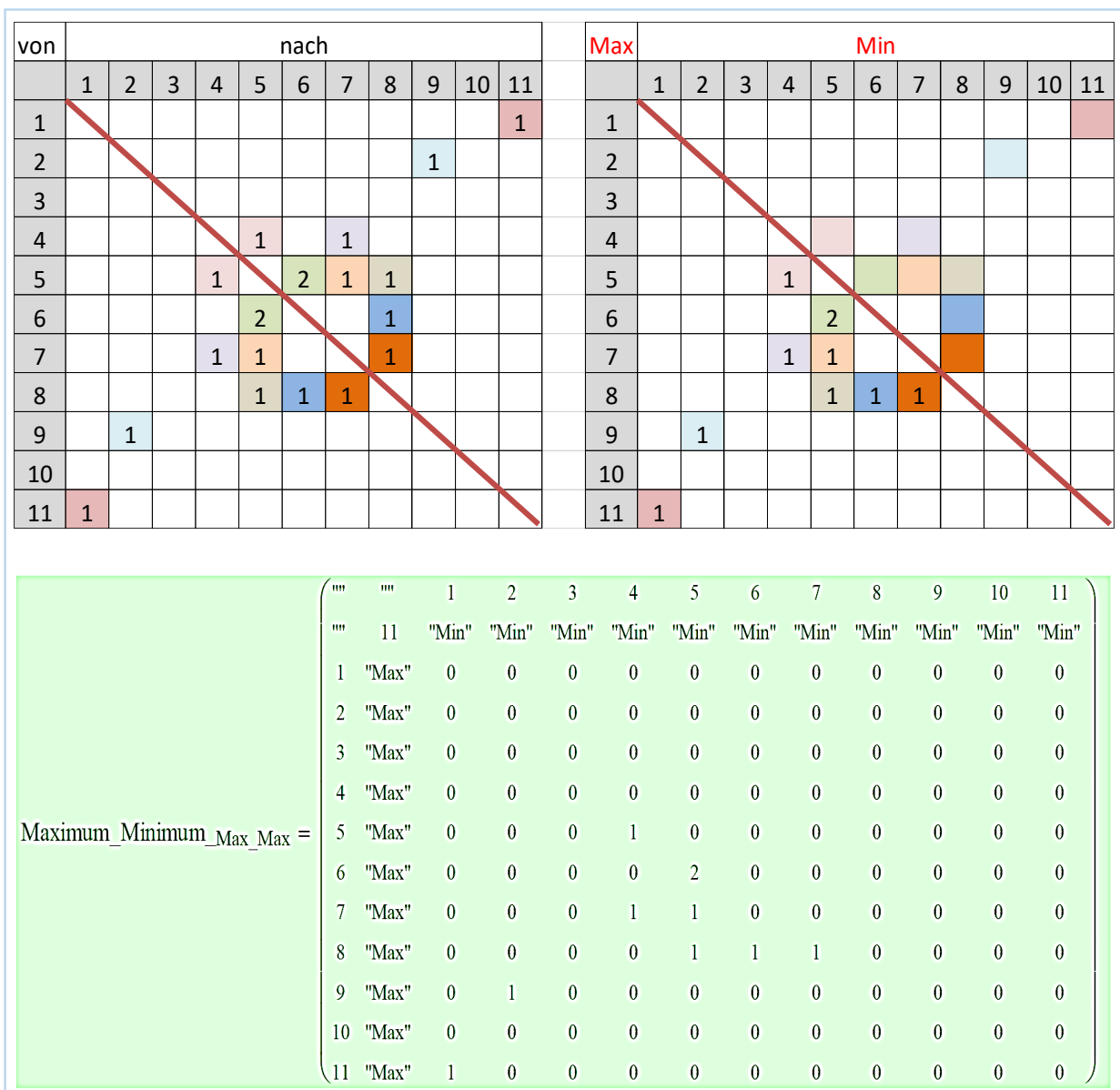
Abb. 4.9 Vergleich der Max_Min-Matrix (mit Verschiebung) des Mathcad-Programms (untere Matrix) mit der händisch berechneten Matrix (zwei obere Matrizen)
