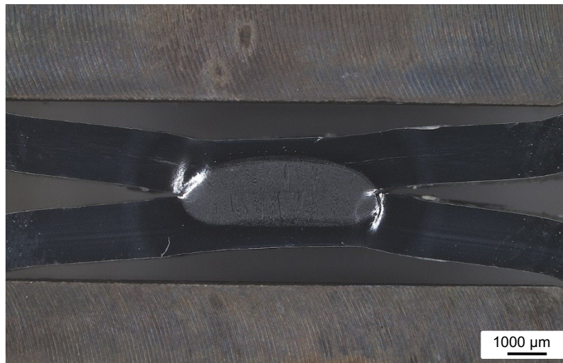
Abbildung 24: Probe S17 bei einer Belastung von 1320 N mit dem Risswachstum in der WEZ. Der Riss verläuft am äußeren Rand des Schweißnuggets in der WEZ entlang.
