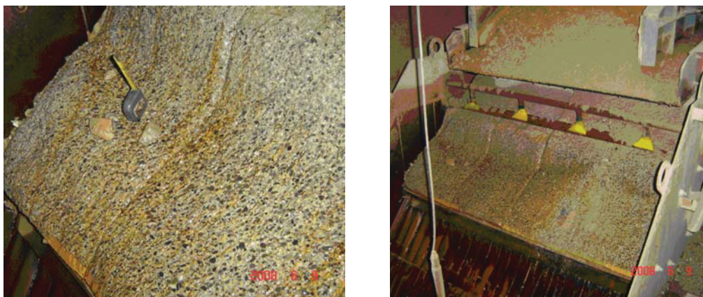
Bild 19: Verschleißbild der Versuchsplatten der zweiten Testserie
