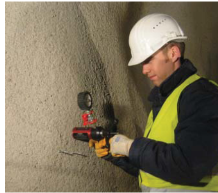
Bild 2: Frühfestigkeitsbestimmung mittels a) Bolzensetzgerät und b) Auszugsgerät
