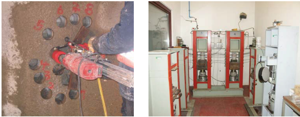
Bild 6: a) Bohrkernentnahme und b) Langzeitversuchsstände
