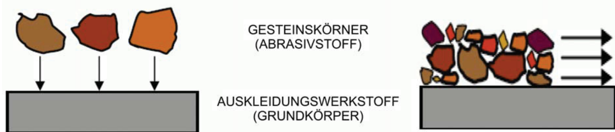
Bild 14: Beanspruchungsarten des Auskleidungswerkstoffes
