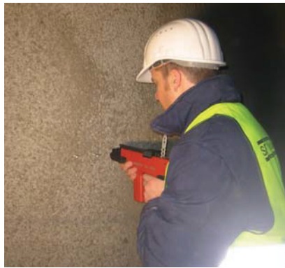
Bild 2: Frühfestigkeitsbestimmung mittels a) Bolzensetzgerät und b) Auszugsgerät
