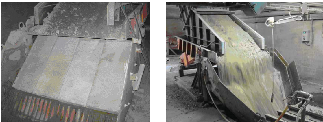
Bild 18: Insitu-Versuche mit Versuchsplatten an einer Materialübergabestelle der Aufbereitungsanlage zur Untersuchung des Verschleißverhaltens
