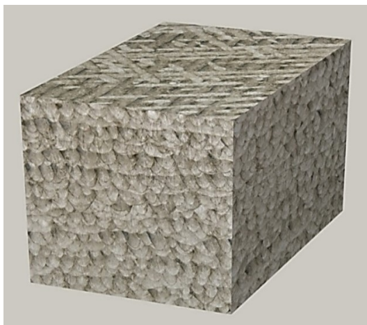
Abbildung 2-6: Darstellung eines aus metallographisch präparierten Schliefflächen zusammengesetzter Beispielwürfel eines schichtweise aufgebauten Probekörpers (Eigene Vorversuche)
