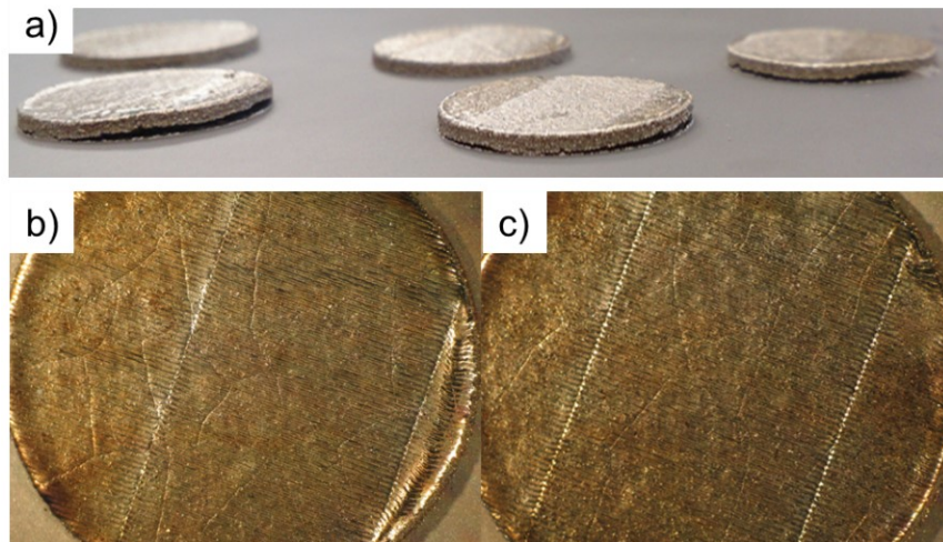
Abbildung 5-9: S390 – a) Delamination zwischen Substratplattform und der zyl. Probekörper (Durchmesser: 20 mm), b) und c) Rissbehaftete Probendeckschichten - b) P=175 W, v=600 mm/s, c) P=225 W, v=900 mm/s
