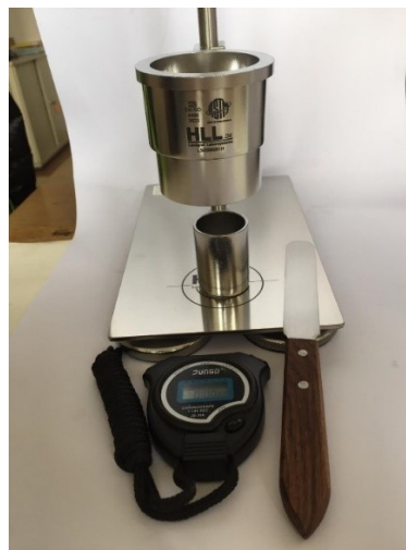
Abbildung 2-29: Aufbau des Hall Flowmeters zur Bewertung der Fließfähigkeit eines granularen Werkstoffs (Standort: Lehrstuhl für Umformtechnik, Montanuniversität Leoben)
