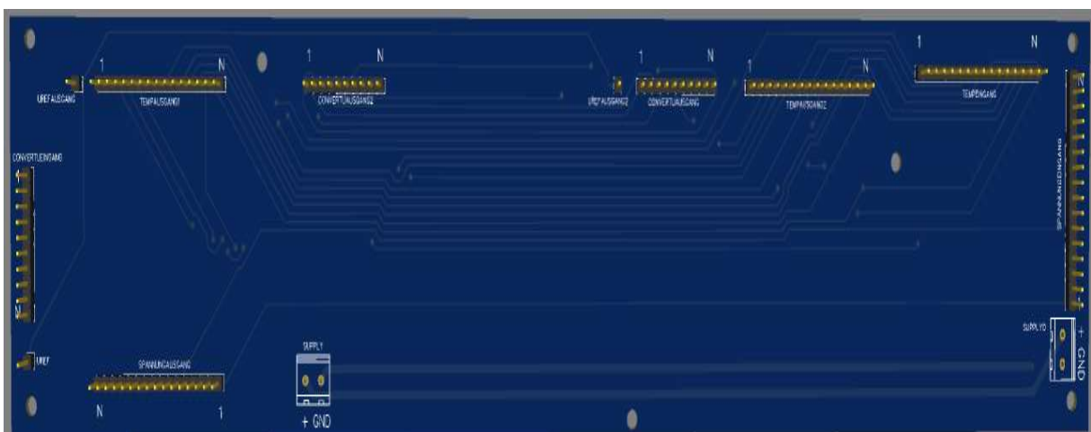
Abbildung 4-32: 3D Ansicht Verteilerplatine
