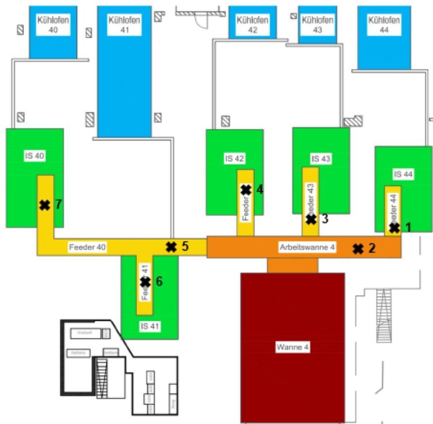
**Abbildung 3-15:** Absaugpyrometermesspunkte an der Braunglasproduktion
