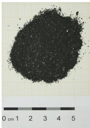
Abbildung 37: Inertstoff aus der  $\text{H}_2\text{SO}_4$ -Laugung von Salzschlacke < 1200  $\mu\text{m}$  Alt
