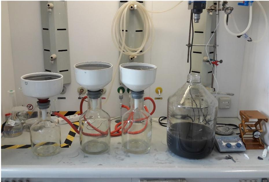
Abbildung 23: Optimierte Filtrierung nach der sauren Laugung im Zuge der Massenbilanzerstellung
