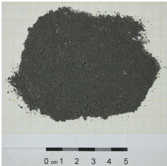
Abbildung 8: Mg-Salzschlacke  $< 1200 \mu\text{m}$  Neu
