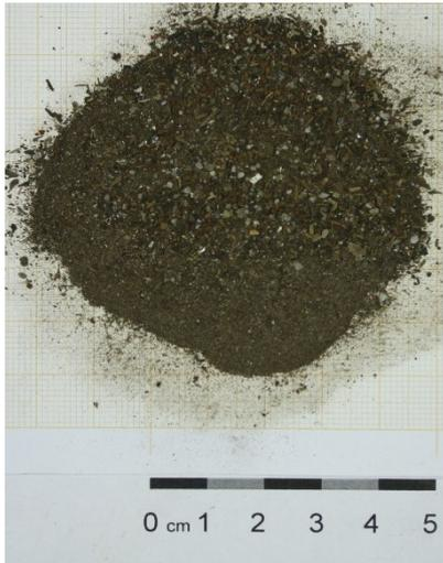
Abbildung 39: Inertstoff aus der  $\text{H}_2\text{SO}_4$ -Laugung von Salzschlacke < 1200  $\mu\text{m}$  Neu
