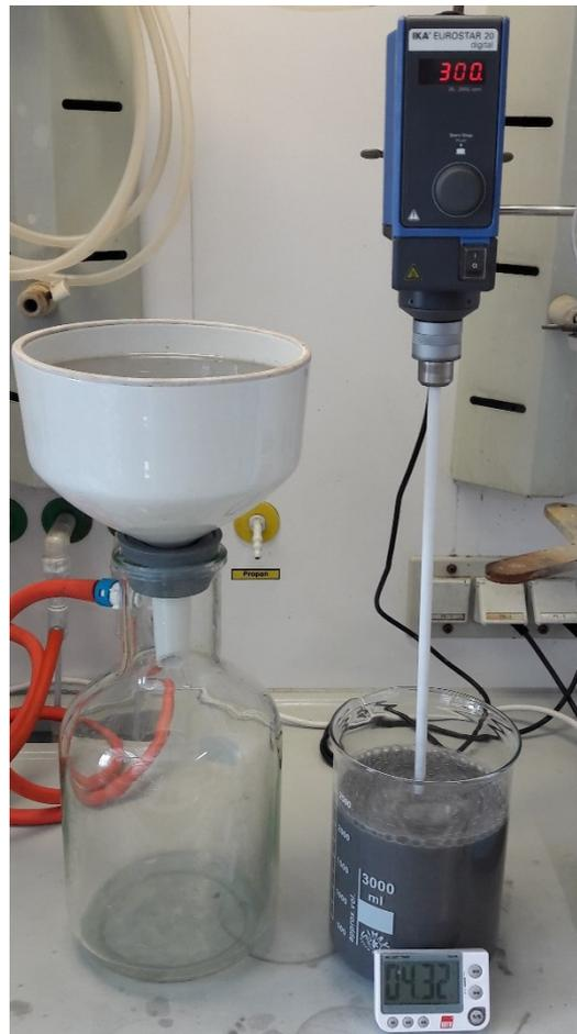
Abbildung 21: Neutrallaugung und Filtration des Reststoffs < 1200 µm Alt im Zuge der Massenbilanzerstellung
