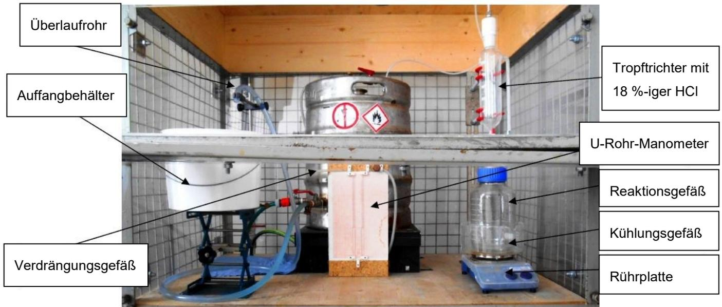
Abbildung 13: Analysevorrichtung zur Bestimmung des Metallgehaltes mittels Wasserstoffverdrängungsmethode [35]
