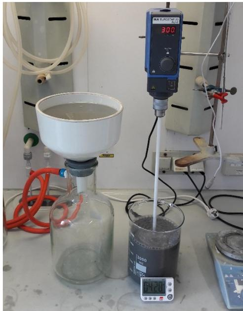
Abbildung 12: Versuchsaufbau der Neutrallaugung des Reststoffs < 1200 µm Alt
