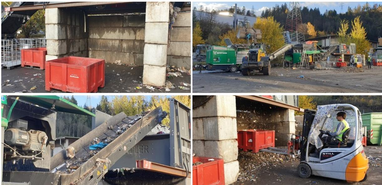
Abbildung 53: v.o.l.n.u.r.: 1) Kompartimente des Ballistikseparators. Zum Ende der Versuche war der Boden verschlammte; 2) Gesamtanlage während eines Versuchs; 3) Auszugsband der Bandwaage; 4) Beprobung des FG<sub>B</sub>.
