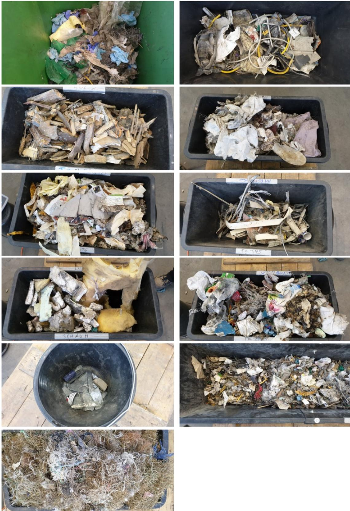
Abbildung 61: v.o.l.n.u.r.: 1) 2D-Kunststoff; 2) 3D-Kunststoff; 3) Holz; 4) Textil; 5) PPK; 6) Metall; 7) Schaumstoff; 8) Verbund; 9) Inert; 10) Rest; 11) Heu.
