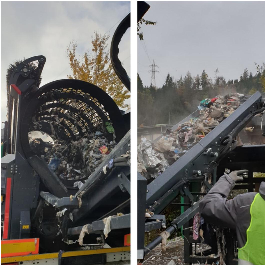
Abbildung 55: von links nach rechts (v.l.n.r.): 1) Restmüll im Trommelsieb; 2) Restmüll am Austrag der Siebmaschine.
