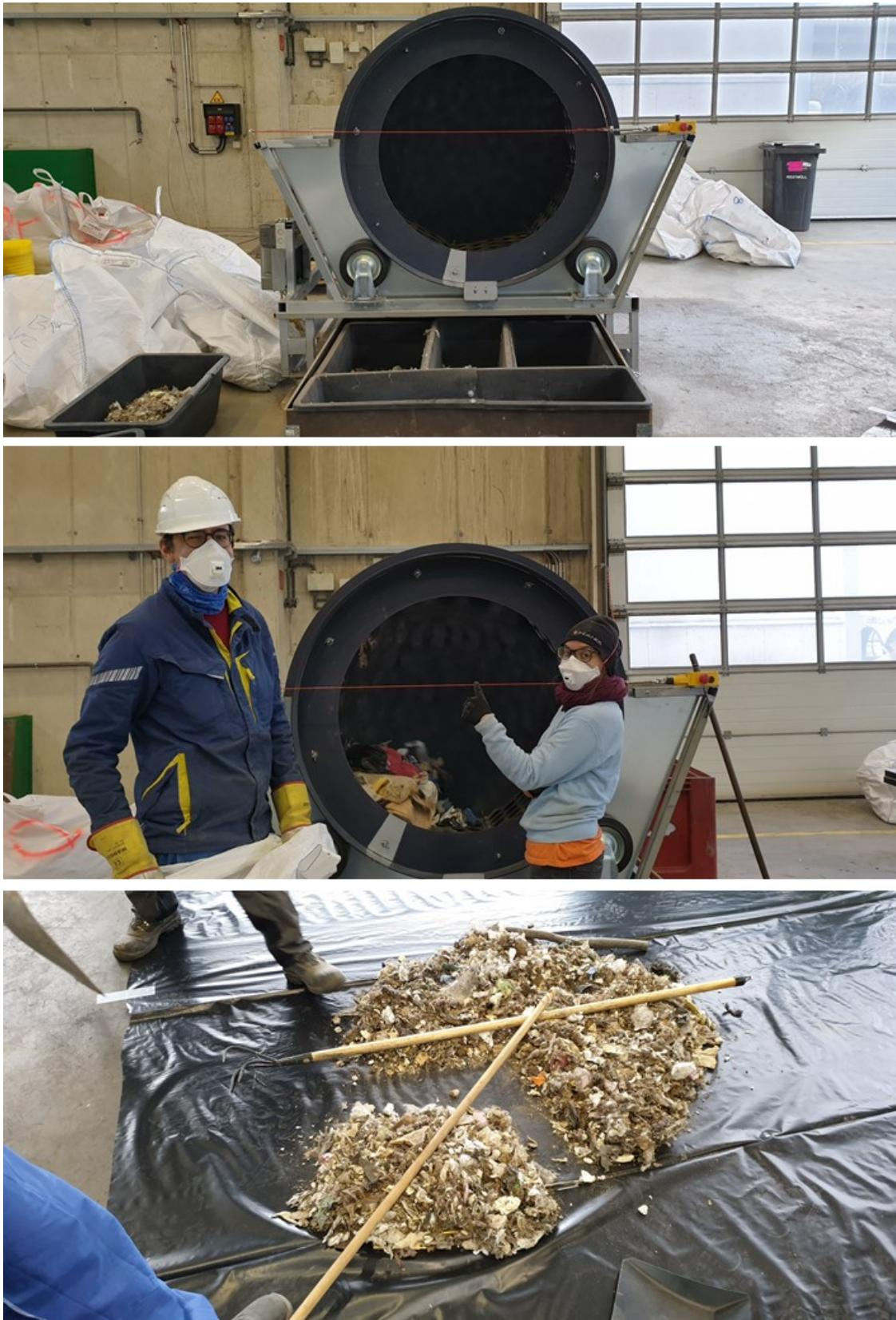
Abbildung 58: v.o.n.u.: 1) Siebanalyse-Trommel des AVAW; 2) Mitarbeiter während einer Siebanalyse; 3) Herstellung einer Laborprobe für weitere Analysen.
