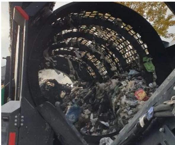
Abbildung 22: Siebtrommel während des zweiten Restmüll-Versuchs mit Anlage 2.
