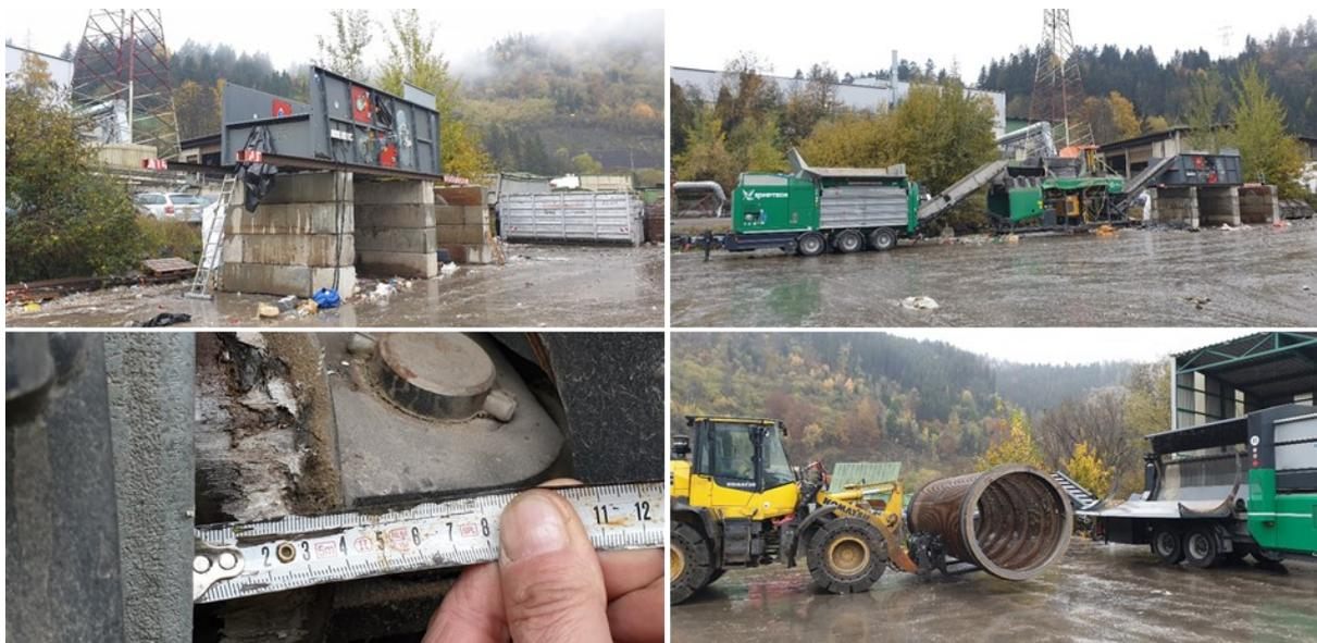
Abbildung 46: von oben links nach unten rechts (v.o.l.n.u.r.): 1) Aufbau der Kompartimente des Ballistikseparators; 2) Aufbau Anlage 1; 3) Einstellung der Schnittspaltbreite; 4) Wechsel des Trommelsiebs.
