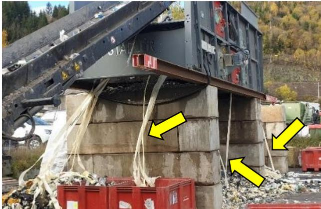
Abbildung 14: Klebebänder in allen Kompartimenten des Ballistikseparators.
