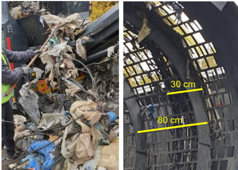
Abbildung 17: Zopfbildung (links) und Filmband-Umwicklung am Trommelsieb (rechts).
