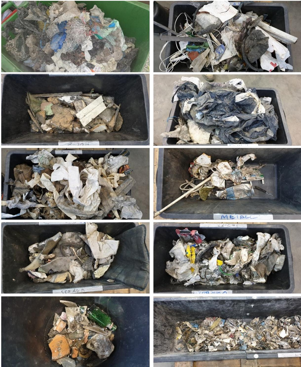
Abbildung 62: v.o.l.n.u.r.: 1) 2D-Kunststoff; 2) 3D-Kunststoff; 3) Holz; 4) Textil; 5) PPK; 6) Metall; 7) Schaumstoff; 8) Verbund; 9) Inert; 10) Rest.
