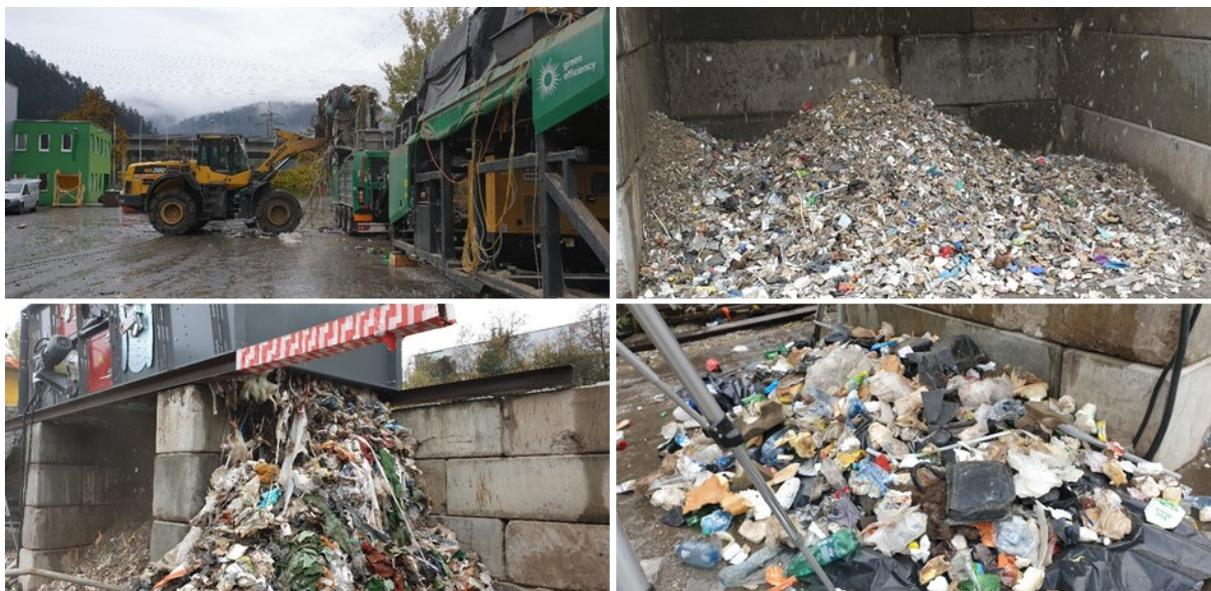
Abbildung 47: v.o.l.n.u.r.: 1) Aufgabe von Gewerbemüll des ersten Tests von Anlage 1; 2) FG-Output; 3) 2D-Output; 4) 3D-Output.
