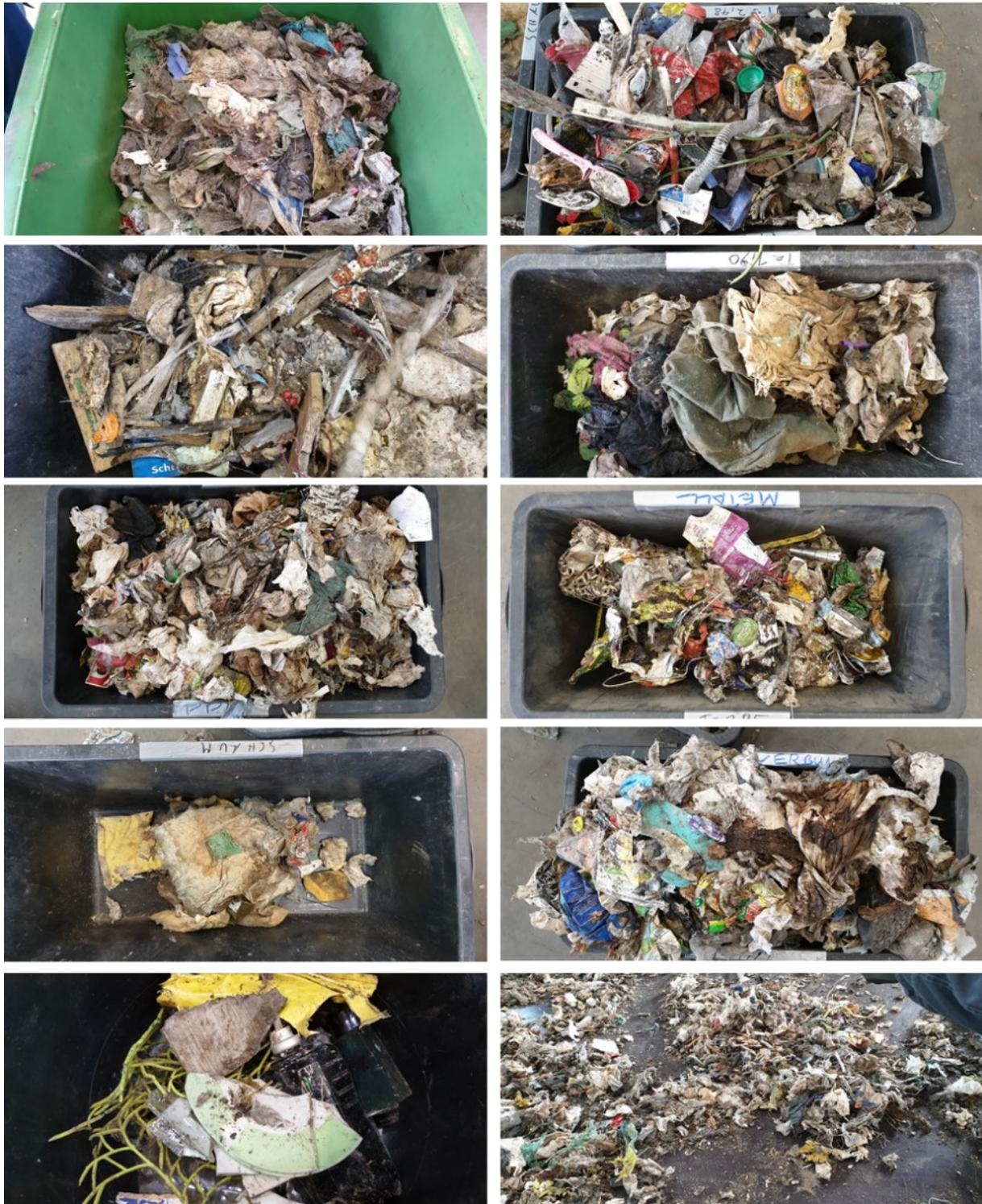
Abbildung 63: v.o.l.n.u.r.: 1) 2D-Kunststoff; 2) 3D-Kunststoff; 3) Holz; 4) Textil; 5) PPK; 6) Metall; 7) Schaumstoff; 8) Verbund; 9) Inert; 10) Rest.
