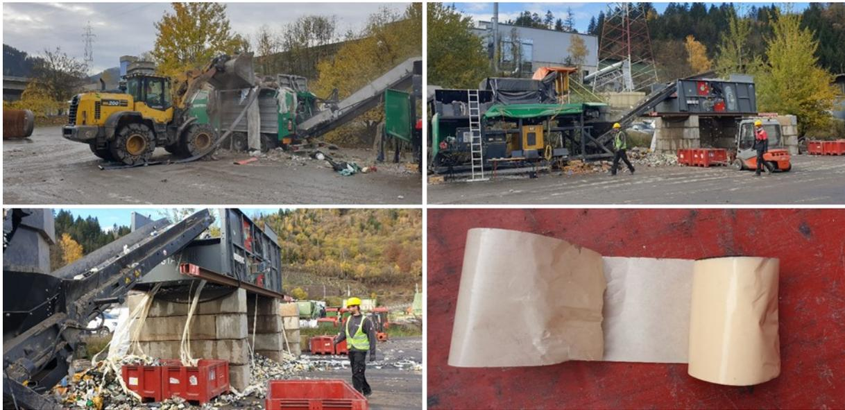
Abbildung 48: v.o.l.n.u.r.: 1) Beschickung des Shredders; 2) Bandwaage und Ballistikseparator während des Versuchs; 3) Störstoffe im Gewerbemüll (vgl. 4.1.1); 4) Störstoff Kunststoffband Nahaufnahme.
