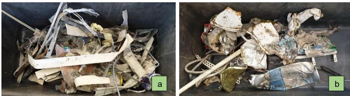
Abbildung 31: Beispielfotos Gewerbemüll: händisch sortierte Metall-Fraktion aus a) Anlage 1 und b) Anlage 2.
