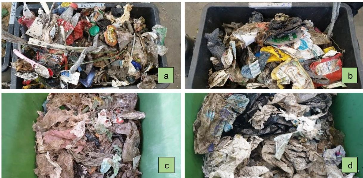
Abbildung 34: Beispielbilder Restmüll: händisch sortierte 3D-Fraktionen der a) Anlage 1, b) Anlage 2 und 2D-Fraktionen aus c) Anlage 1 und d) Anlage 2.
