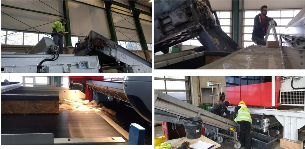
Abbildung 65: v.o.l.n.u.r.: 1) Vereinzelung von Aufgabeband zum Beschleunigungsband der Anlage; 2) Schurren von Aufgabeband auf Beschleunigungsband; 3) Sortiergut im Sensorbereich; 4) In-line-Sortierung von Fehlwürfen.
