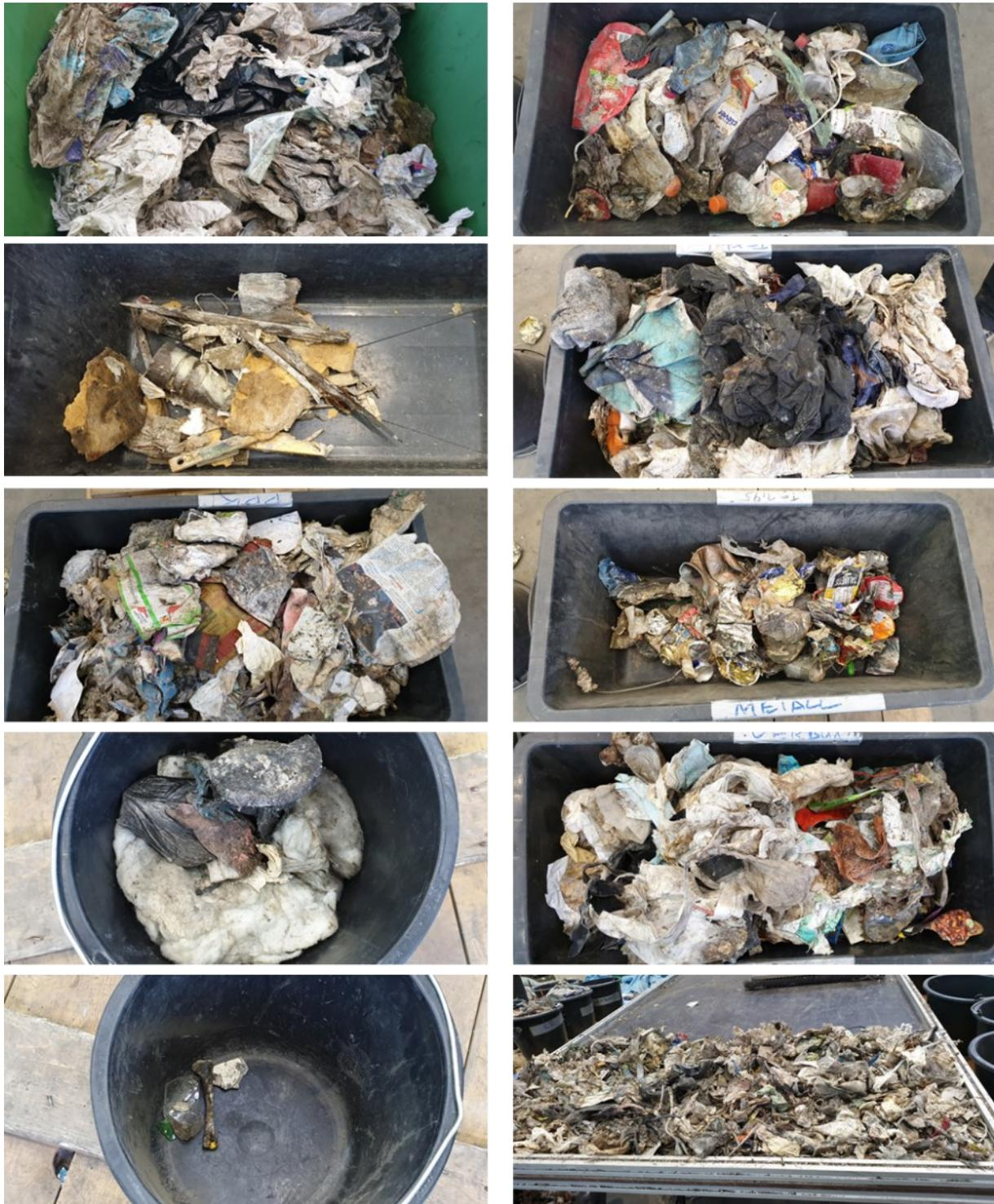
Abbildung 64: v.o.l.n.u.r.: 1) 2D-Kunststoff; 2) 3D-Kunststoff; 3) Holz; 4) Textil; 5) PPK; 6) Metall; 7) Schaumstoff; 8) Verbund; 9) Inert; 10) Rest.
