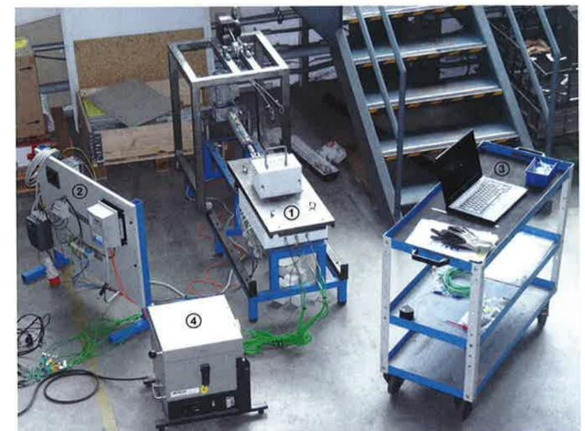
Bild 1: Gießanlage: Gießeinheit (1), Steuereinheit (2), Datenaufzeichnung (3), Schmelzeinheit (4).
