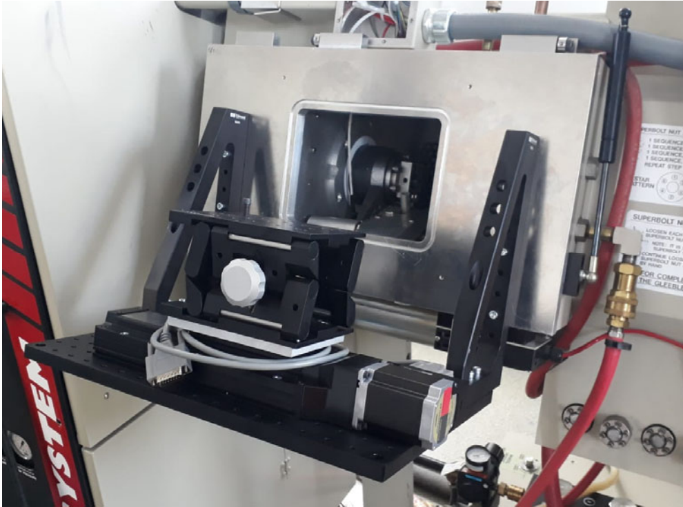
Abbildung 20: Anregungsseite der LUS-Anlage mit einer Stage.
