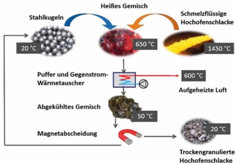
Abbildung 15: Schematische Darstellung des technischen Konzepts der Paul Wurth Anlage [27]
