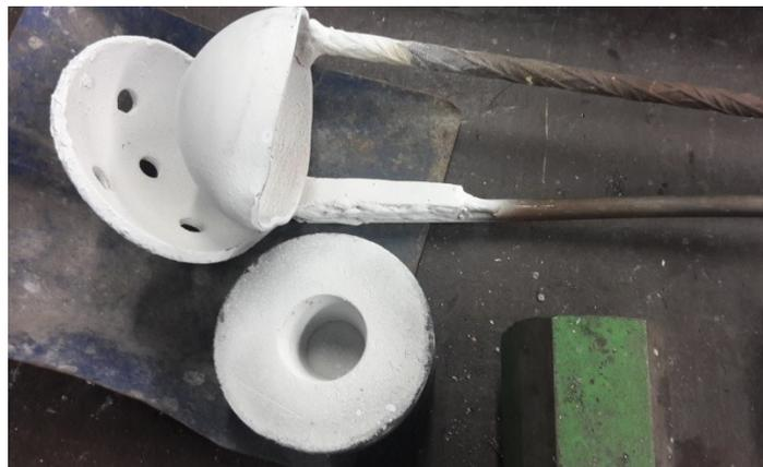
Abbildung 24: Darstellung von Schöpfer, Löffel und Kokille, geschlichtet mit Bornitrid
