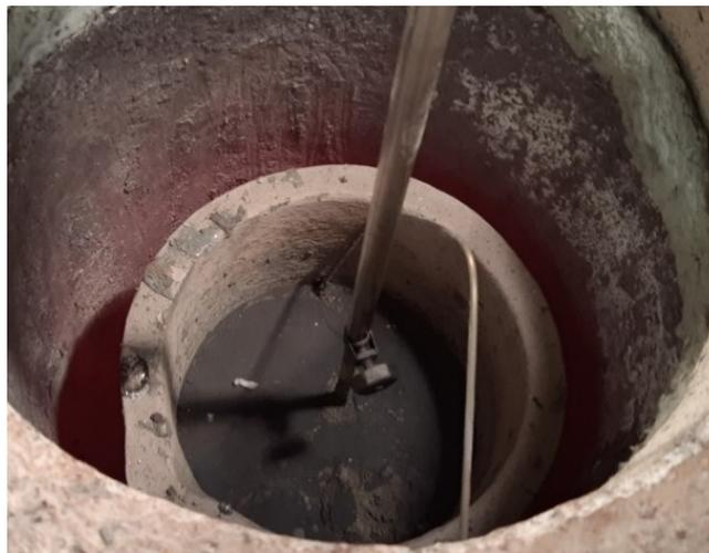
Abbildung 27: Verunreinigungen durch Pulverschicht bei Versuch 3
