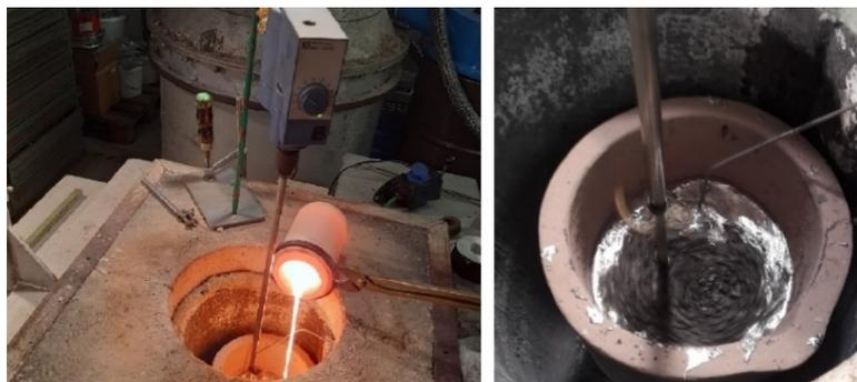
Abbildung 26: Darstellung von Versuch 1: Eingießen der Schlacke (links), granuliert Schlacke (rechts)
