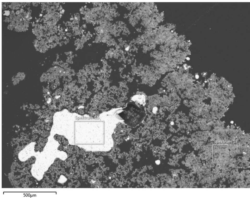
Abbildung 56: Elektronenbild 3 der granulierten Schlacke von Versuch 4
