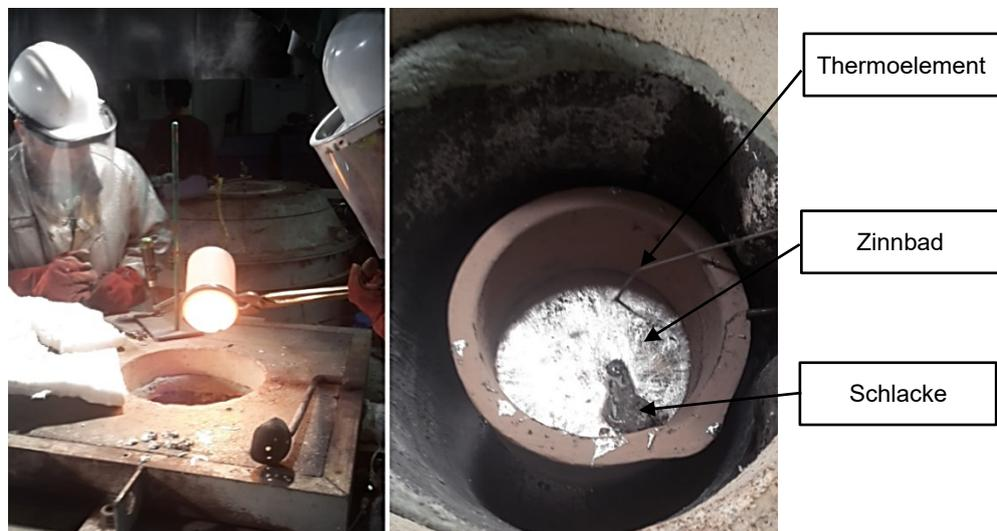
Abbildung 25: Darstellung von Versuch 0: Kurz nach dem Einkippen der Schlacke (links), aufschwimmende Schlacke (rechts)
