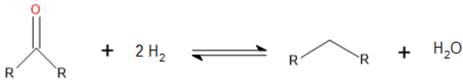
Abbildung 4: Schematischer Reaktionsmechanismus einer Hydrodeoxygenierung
