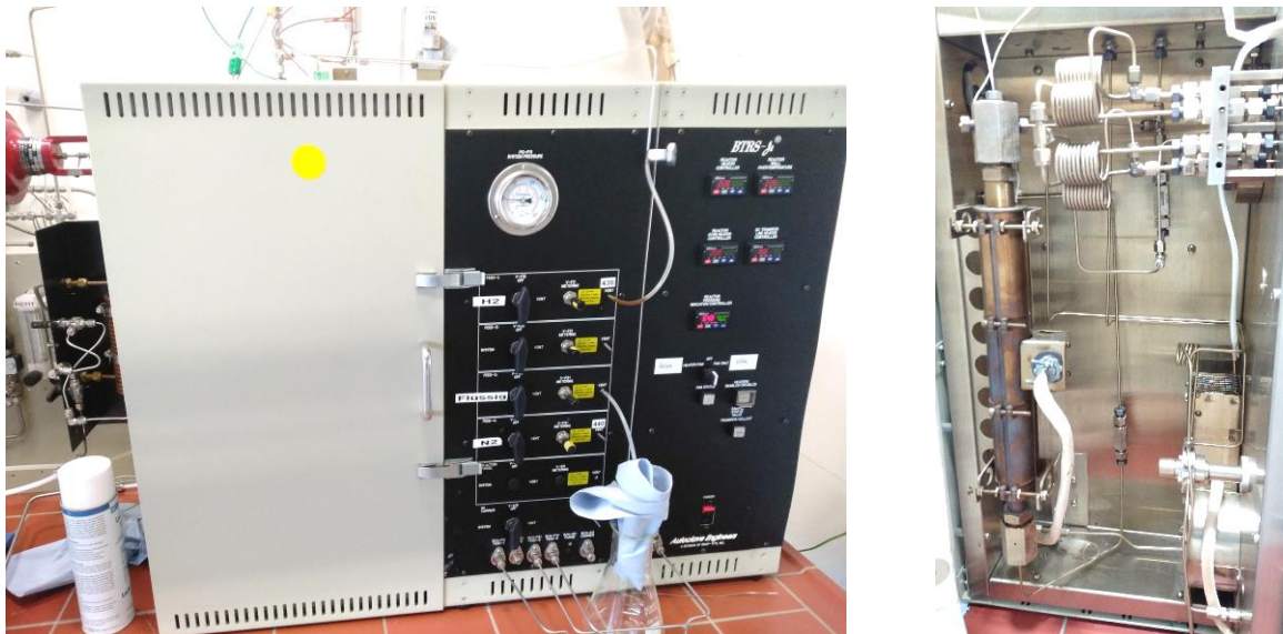
Abbildung 14: Reaktorteil der Anlage (links) und Detailbild des Reaktorinnenlebens mit Zuleitungen zum Festbettreaktor (rechts)
