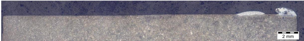
**Abbildung 4-32:** Montageaufnahme Oberfläche der 10 Sekunden C90-Probe; V~5:1
