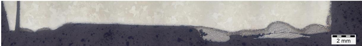
**Abbildung 4-16:** Montageaufnahme Oberfläche der 90 Sekunden Reineisenprobe; V~5:1
