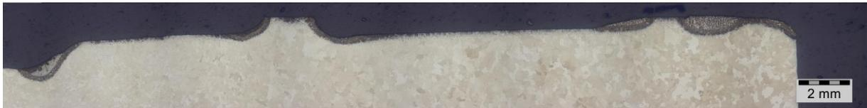
**Abbildung 4-15:** Montageaufnahme Oberfläche der 60 Sekunden Reineisenprobe; V~5:1
