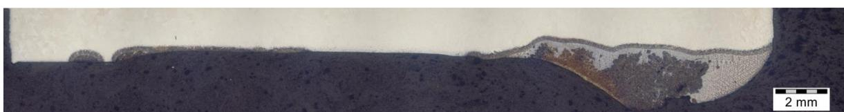
**Abbildung 4-14:** Montageaufnahme Oberfläche der 30 Sekunden Reineisenprobe; V~5:1
