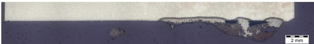
**Abbildung 4-12:** Montageaufnahme Oberfläche der 10 Sekunden Reineisenprobe; V~5:1
