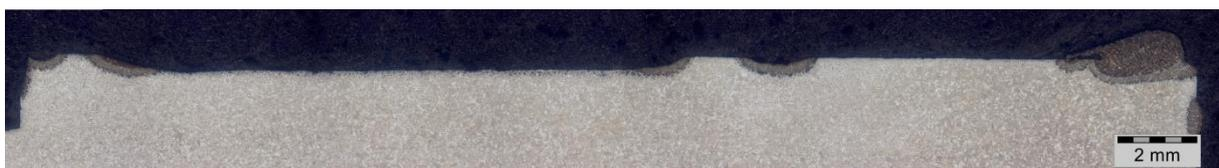
**Abbildung 4-24:** Montageaufnahme Oberfläche der 30 Sekunden S235JR-Probe; V~5:1
