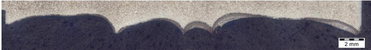
**Abbildung 4-26:** Montageaufnahme Oberfläche der 90 Sekunden S235JR-Probe; V~5:1
