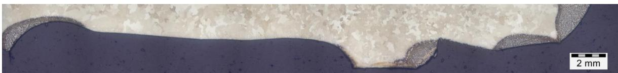
**Abbildung 4-17:** Montageaufnahme Oberfläche der 120 Sekunden Reineisenprobe; V~5:1
