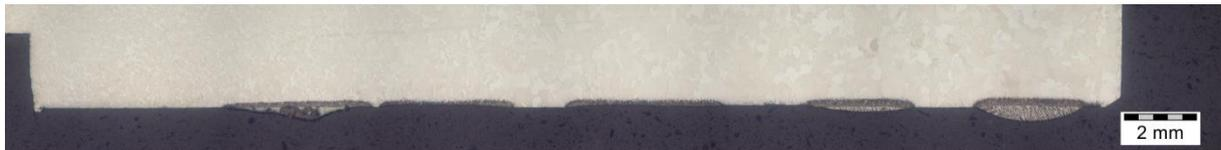
**Abbildung 4-11:** Montageaufnahme Oberfläche der 5 Sekunden-Reineisenprobe; V~5:1
