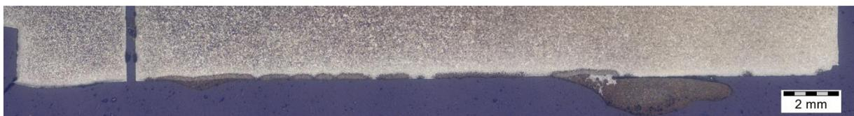
**Abbildung 4-21:** Montageaufnahme Oberfläche der 5 Sekunden S235JR-Probe; V~5:1
