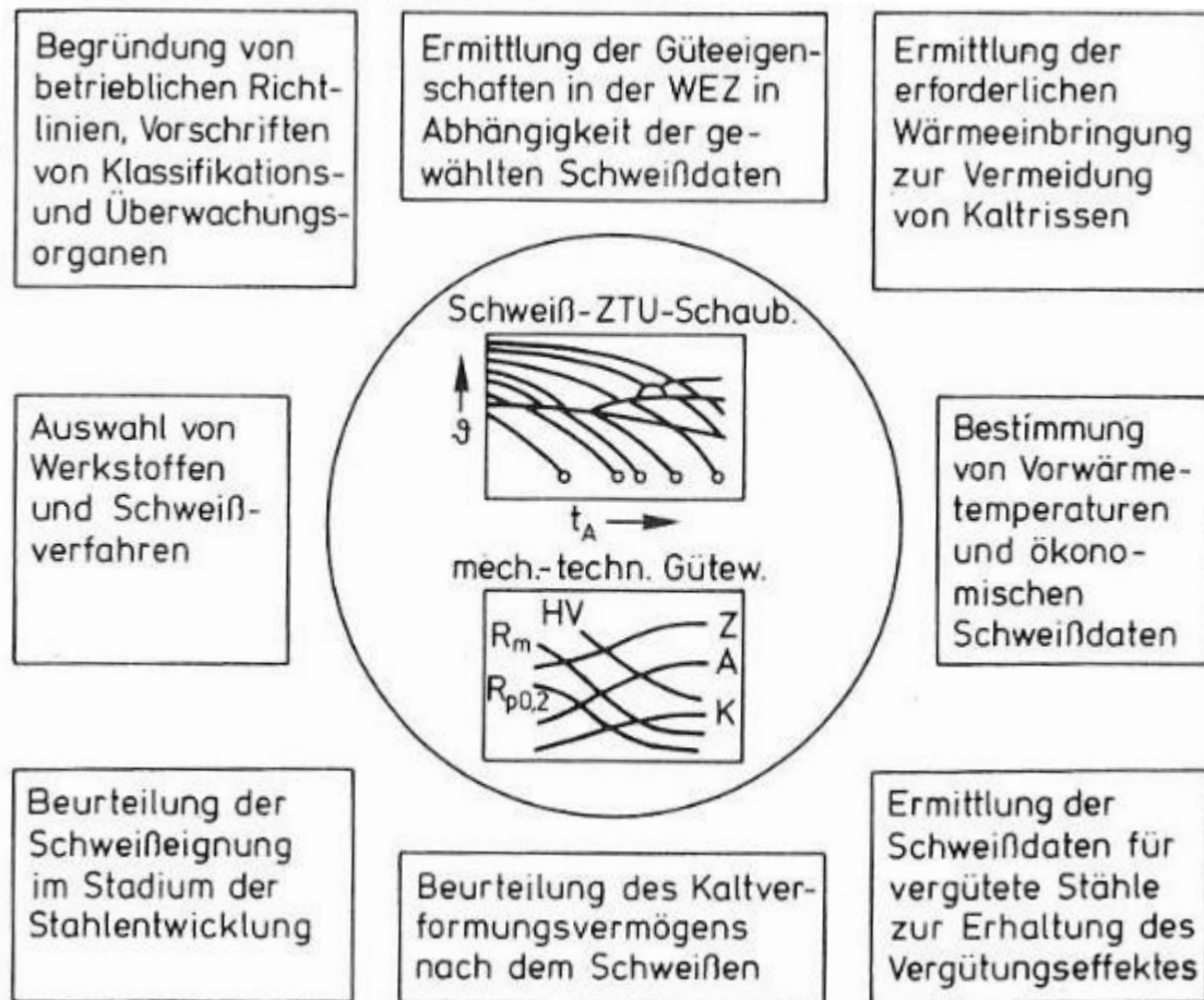
Abbildung 13: Anwendungsbeispiele von Schweiß-ZTU-Schaubildern [8].
