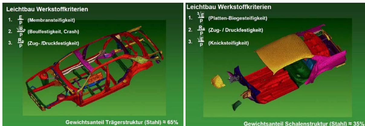
Abbildung 1: Links: Werkstoffkriterien für die Trägerstruktur eines Kfz; Rechts: Werkstoffkriterien für die Schalenstruktur eines Kfz. [1]
