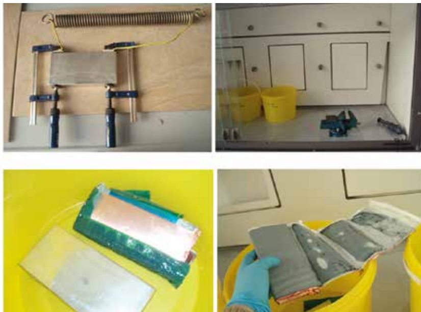
(1) Zelle entladen um Risiko zu minimieren, (2) Laborabzug Dremel und Einspannmöglichkeit, (3) Zellgehäuse und (4) Folienpaket
