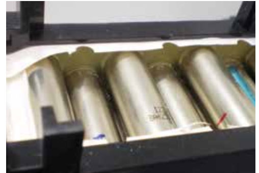
Aufbau einer Traktionsbatterie aus Rundzellen
