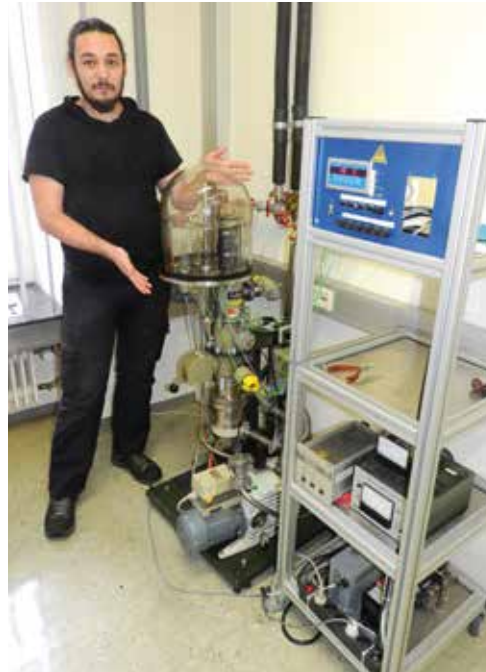
Dr. Aleksandar Matković vor der Epitaxie-Anlage, an der die Messungen des Ladungstransfers bei der Bedampfung des Graphen mit organischen Halbleitermolekülen durchgeführt wurden.
