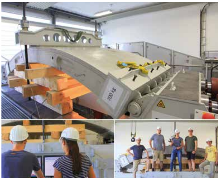
Groß-Prüfstand zur Optimierung von Tübbing in Niklasdorf
