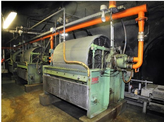
Abbildung 4: Vakuumentrommelfilter in der Versatzanlage, Wolframbergwerk Mittersill
