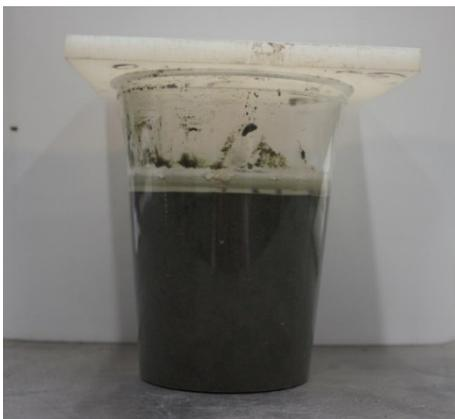
**Abbildung 2: Versuchsaufbau zur Feststellung der Blutwassermenge; abgedeckter Kunststoffbecher mit Versatzmischung**
