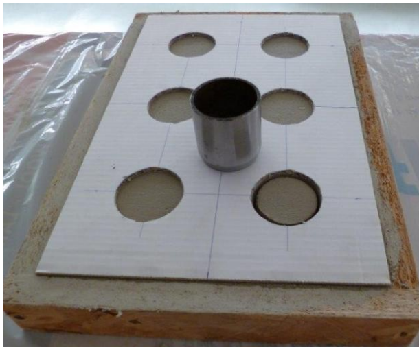
Abbildung 8: Eindrücken der Ringschalung
