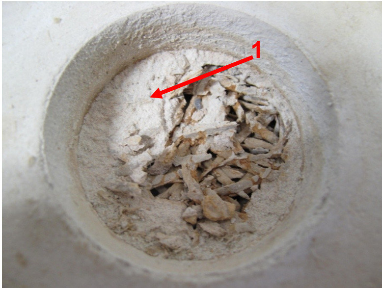
Abbildung 35: Aufnahme nach dem 18. Zyklus 1 Mörtel, welcher auf der Grenzschicht verblieben ist
