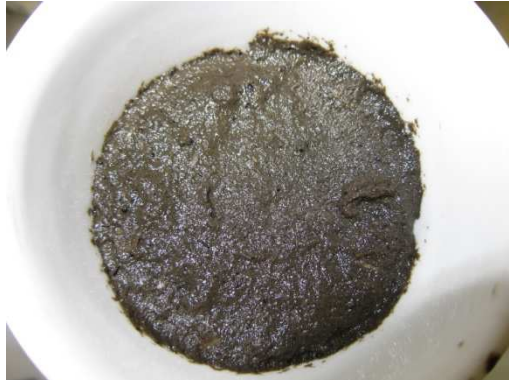
Abbildung 38: Foto eines im Zuge der Filtration der Gärrestprobe A1 mit FM_6 erzeugten Filterkuchens
