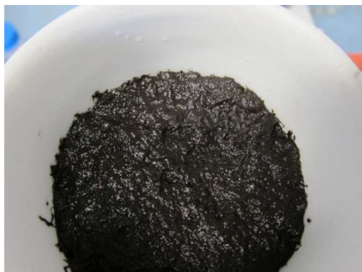
Abbildung 44: Foto eines im Zuge der Filtration der Gärrestprobe C1 mit FM_6 erzeugten Filterkuchens
