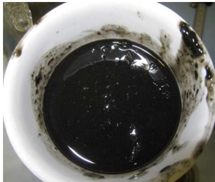
Abbildung 41: Foto eines im Zuge der Filtration der Gärrestprobe B1 mit FM_6 erzeugten Filterkuchens
