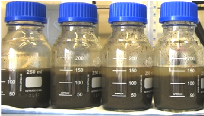
Abbildung 34: Beispielhafte Durchführung eines Jar-Tests
