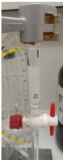
Abbildung 27: Säulenchromatographie I mit stationärer Phase
