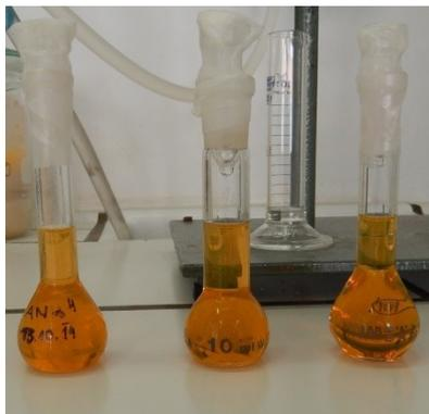
Abbildung 28: Gewonnene aprikosen-farbige organische Phase nach dem Trocknungsprozess
