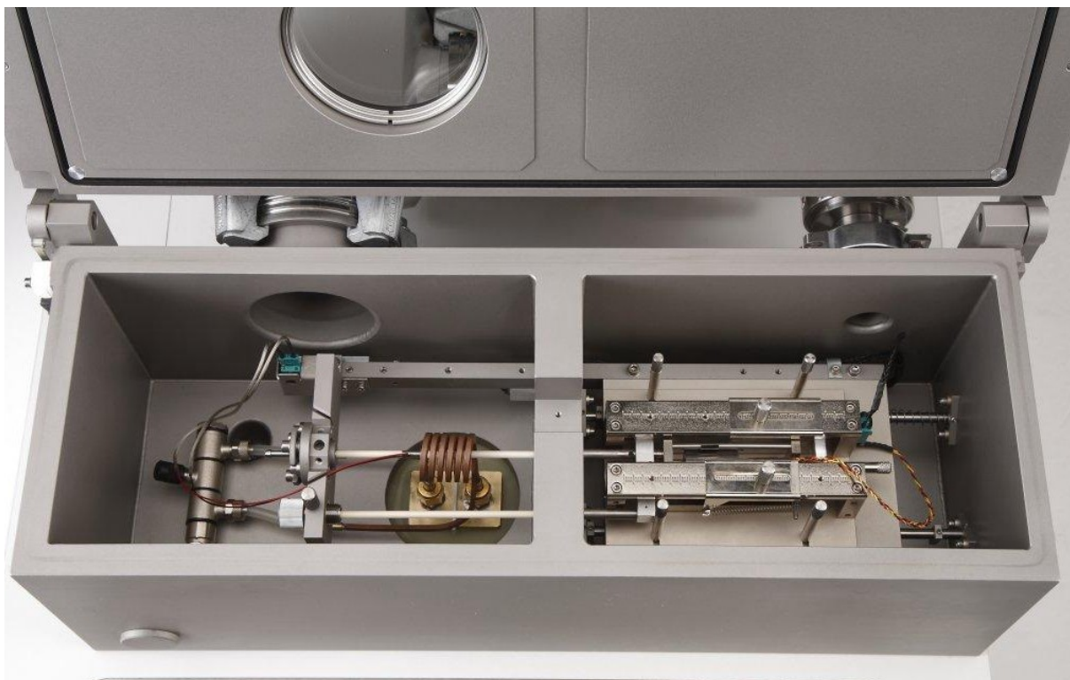
Abbildung 32: Messaufbau im Dilatometer der Firma TA Instruments vom Typ DIL 805L
