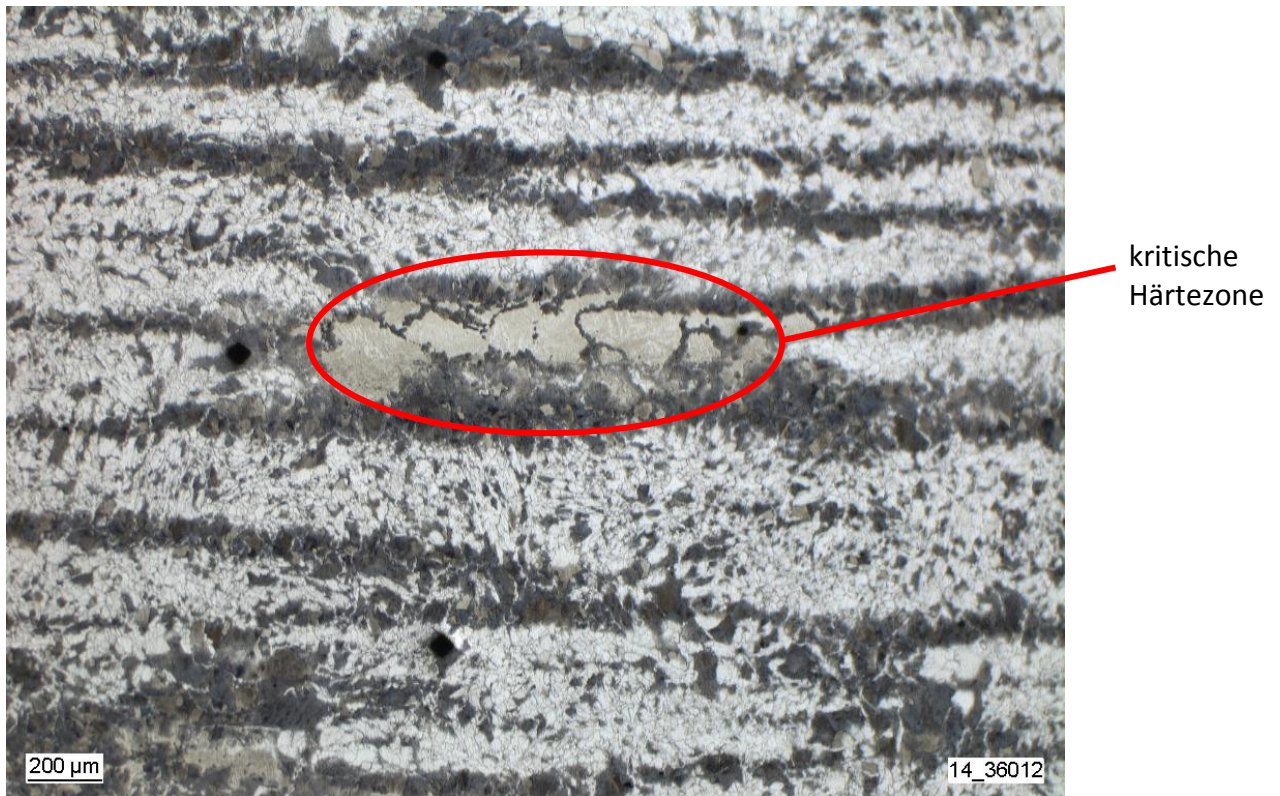
Abbildung 22: Lichtmikroskopische Aufnahme der Messposition der ESMA
