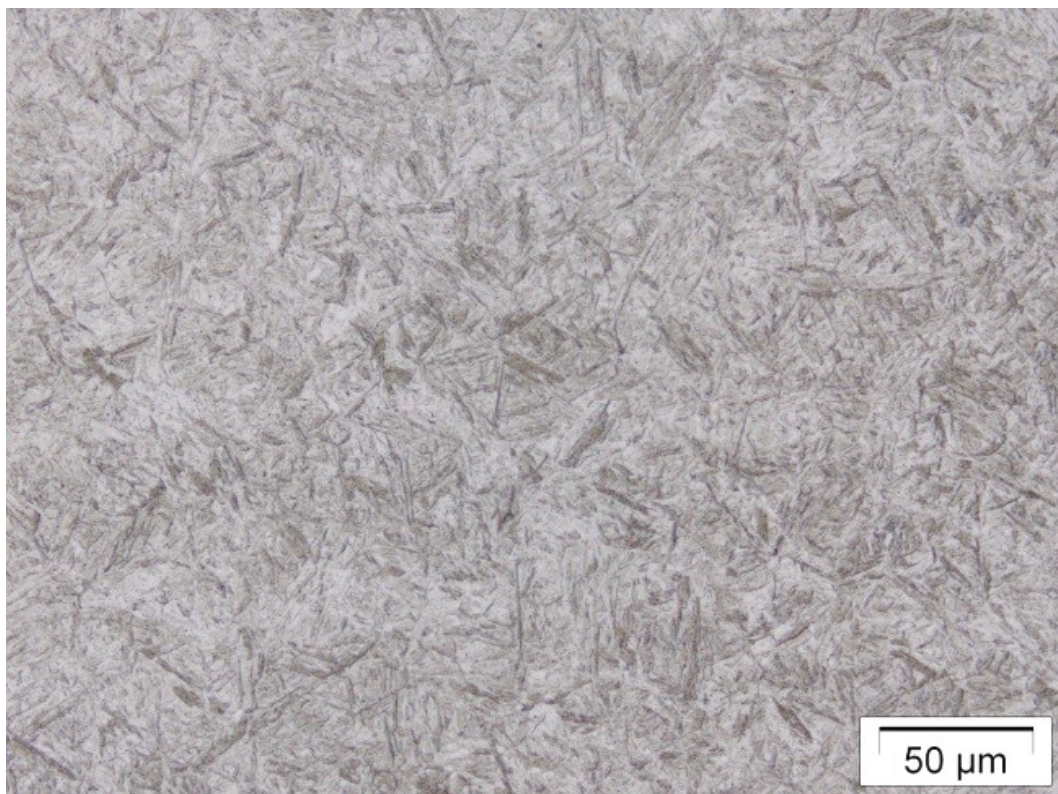
Abbildung 51: Versuchslegierung B, T_A=870^\circ\text{C} , t_A=1 h, rasche Abkühlung unter M_S
