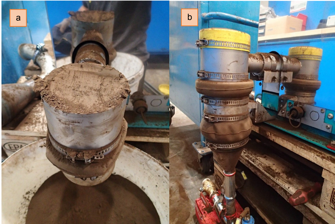
Abbildung 4.1: Verstopfung im Austragsrohr (a); Austragseinheit (b)
