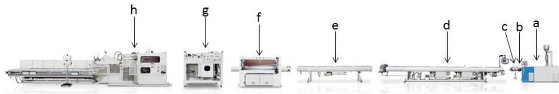
Abb. 2.1: Anschauungsbild einer Anlage für das Extrudieren von PP-Rohren [3].
