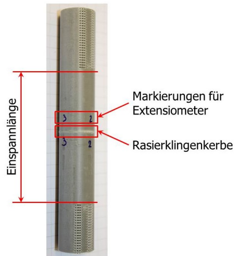
Abb. 3.10: Aufnahme eines CRB-Prüfkörpers mit Mittelkerbe.
