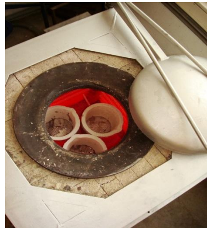
Abb. 3-3: Chargierung von drei Tiegeln mit je 2 kg Schmelze
