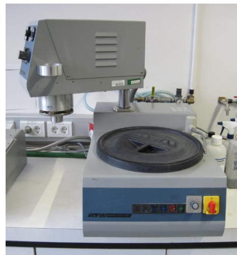
Abb. 3-7: Schleif- und Poliermaschine ATM® Saphir 350 E am LfGK.
