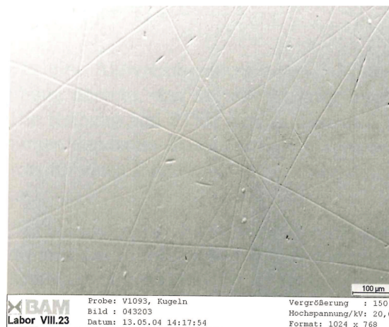
Abbildung 2.26: Riefenbildung (Kugeloberfläche) bei einem Kugellagertest in LHe; F_N = 400 \text{ N} ; n = 3000 \text{ min}^{-1} [33]
