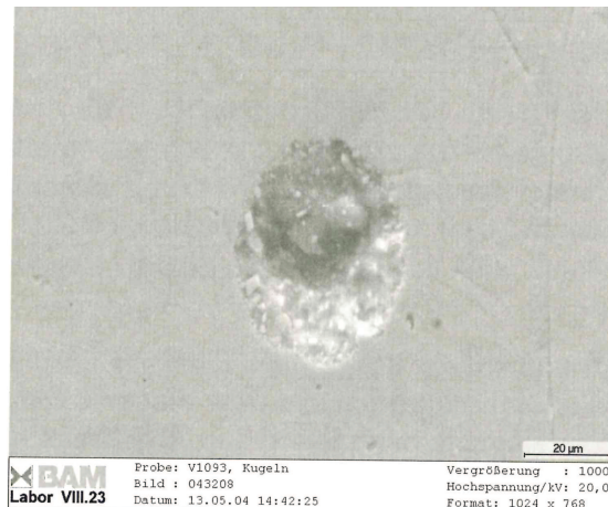
Abbildung 2.27: Ausbrüche (Kugeloberfläche) bei einem Kugellagertest in LHe; F_N = 400\text{ N} ; n = 3000\text{ min}^{-1} [33]
