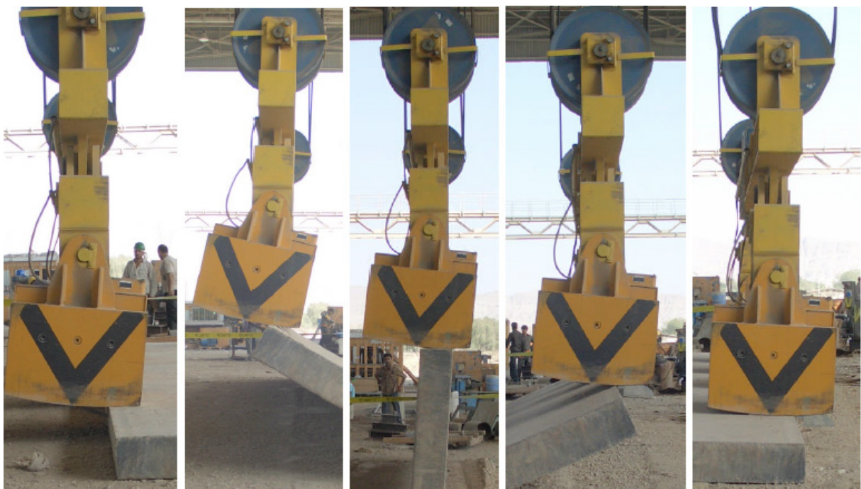
Abbildung 9: Magnetisches Wenden einer Bramme 13
