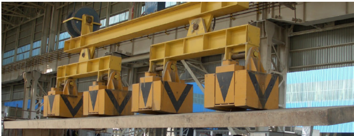
Abbildung 8: Entstapeln einer Bramme 11
