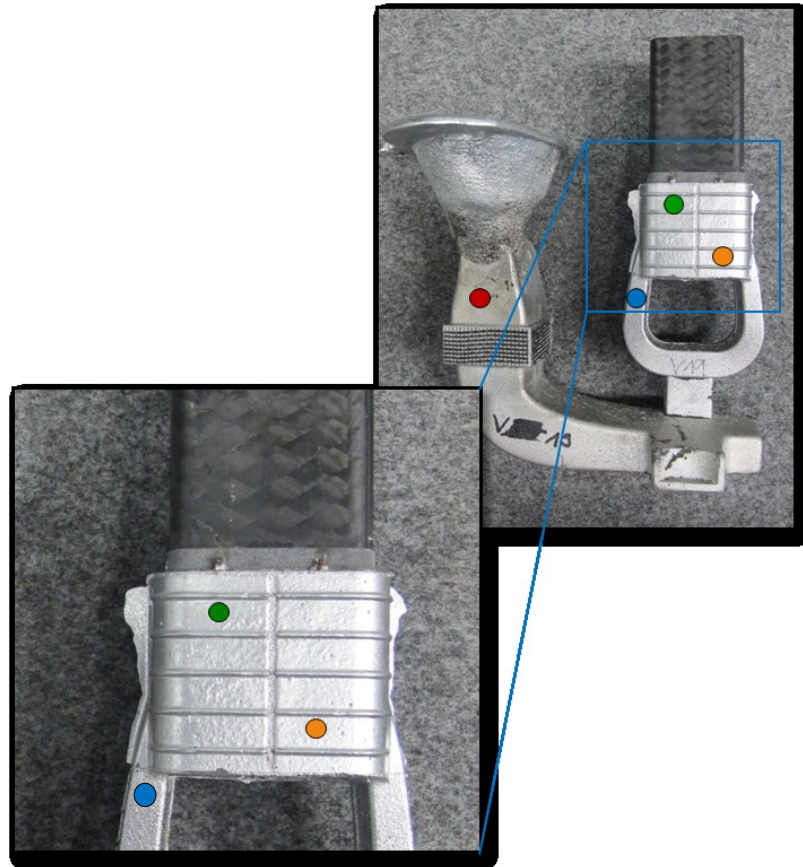
Abbildung 6.5: Positionen der Messpunkte am Gussknoten; rot: Element Filter, blau: Element Zulauf, grün: Element oben (innen und außen), orange: Element unten (innen und außen)
