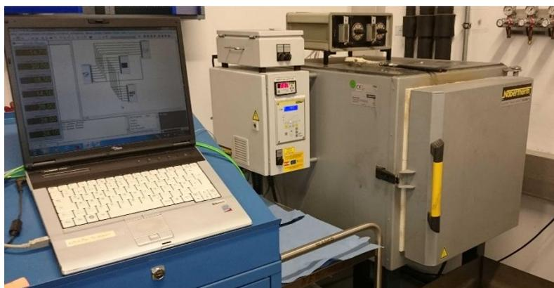
Abbildung 34: Ofen und Computer zur Temperaturaufzeichnung
