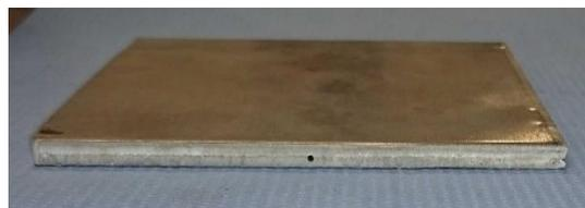
Abbildung 40: Dummy-Probe mit Loch zur Aufnahme des Thermoelementes
