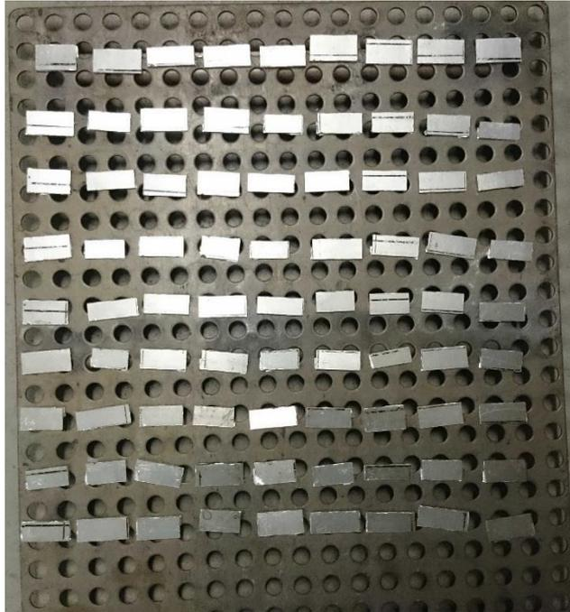
Abbildung 55: Härteproben für Auslagerungskurve für Proben mit 2 mm
