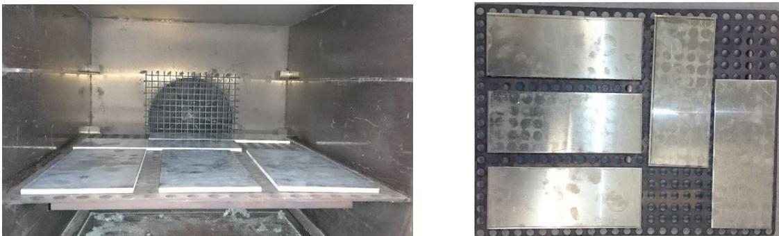
Abbildung 49: Probenanordnung beim Lösungsglühen
