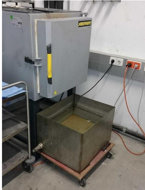
Abbildung 50: Kammerumluftofen mit dem davorstehenden Wasserbad
