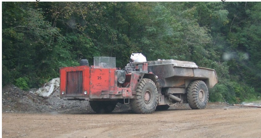
Abbildung 43: Muldenkipper vor der Zufahrt zum Stollensystem in der Breitenau
