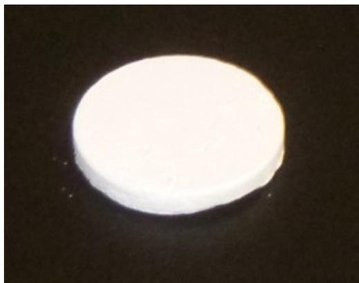
**Abbildung 25: Gießpulvertablette (23 mm Durchmesser und 1 mm Höhe)**
