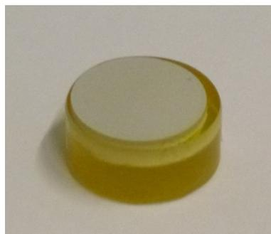
Abbildung 20: Polierte Probe (30 mm Durchmesser und 20 mm Höhe)
