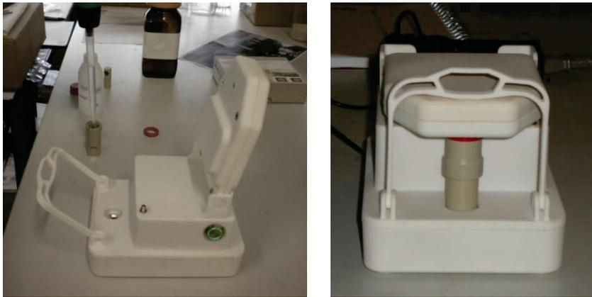
Abbildung 4: Front- und Seitenansicht des elektrometrischen DOC/TOC-Analysators
