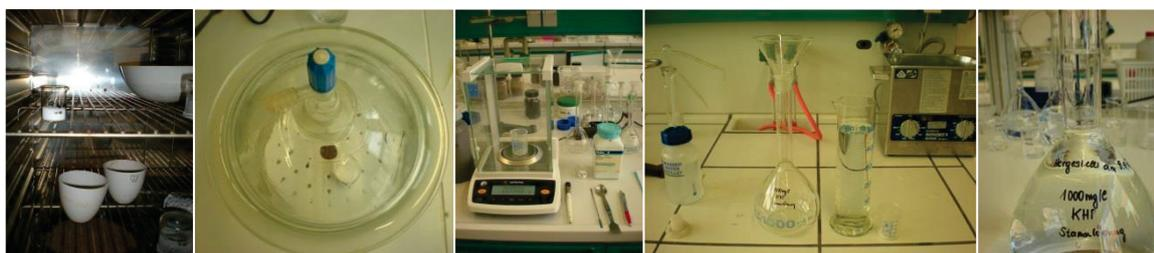
Abbildung 8: Herstellung der KHP-Lösung mit c (TOC) = 1000 mg/l
