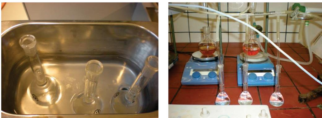
Abbildung 19: Behandlung der Proben im US-Bad (links) und mit N<sub>2</sub>-Gas (rechts) – V. 14
