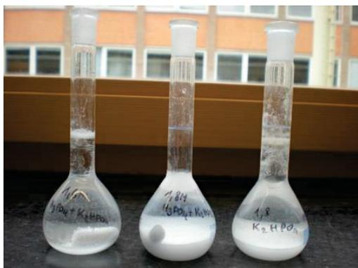
Abbildung 20: Nicht gelöstes  $\text{K}_2\text{HPO}_4$  in Phosphorsäure und destilliertem Wasser – V. 1
