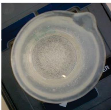
Abbildung 21: Niederschlagbildung nach Umleeren der  $K_2HPO_4$ -Pufferlösung – V. 1
