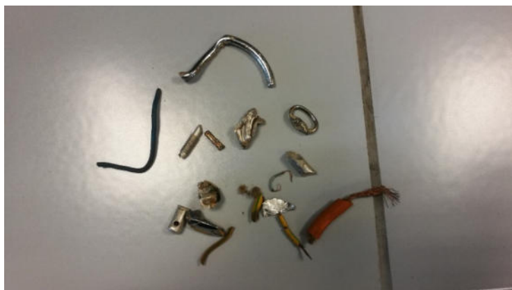
Abbildung 52: Beispiele nicht ausgetragener NE-Metallteile (eigene Aufnahme).
