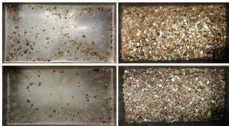
Abbildung 59: Braunglasprodukt des nass- (links) und trockenmechanisch (rechts) aufbereiteten gemischten Siedlungsabfalls.
