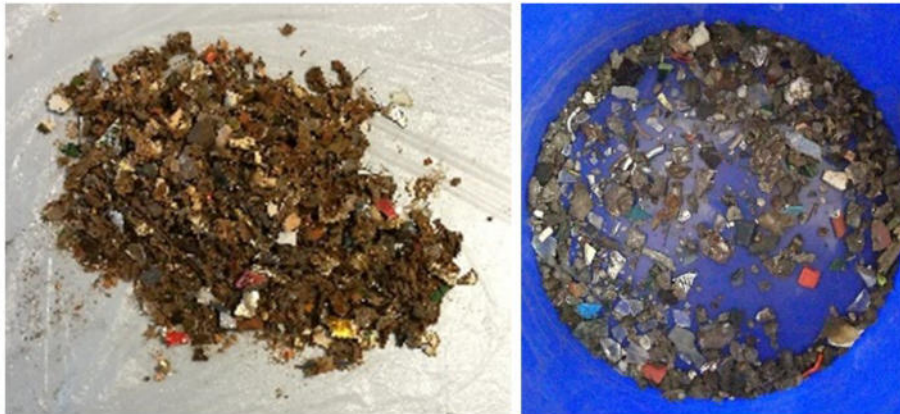
Abbildung 43: Schwergut der Nassmechanischen (links) und der trockenmechanischen Aufbereitung (rechts) (eigene Darstellung).
