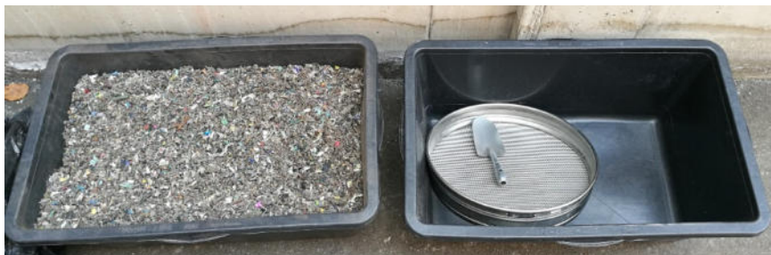
Abbildung 29: Handsiebung, links: zerkleinertes Inputmaterial, rechts: verwendetes Werkzeug (eigene Aufnahme).
