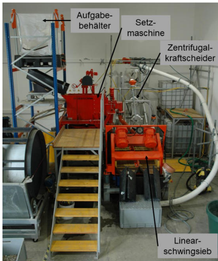
Abbildung 26: Aufnahme der Anlage aus dem Projekt „Plastic Reborn“ (Schwabl 14.09.2019).
