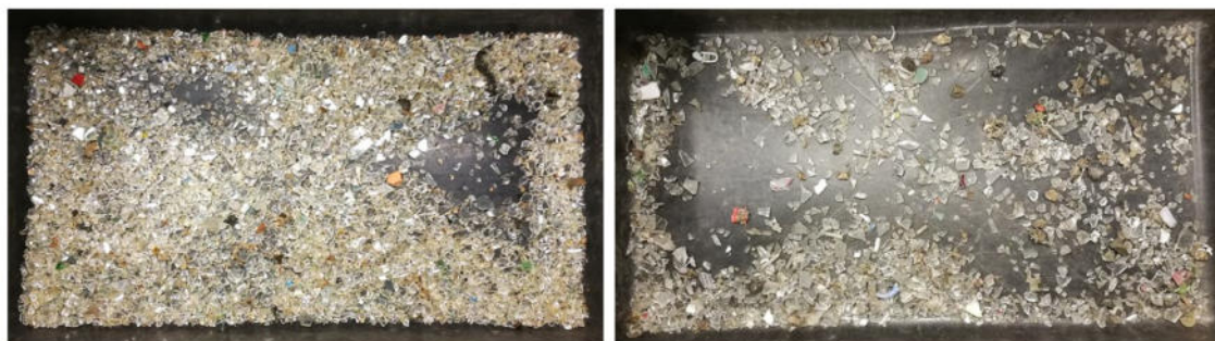
Abbildung 53: Weißglasprodukte des Nass- (links) und trockenmechanisch (rechts) aufbereiteten Siedlungsabfalls (eigene Aufnahme).
