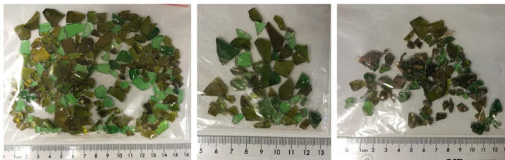
Abbildung 58: Nicht erkannte Grünglaspartikel des Nass- (links) und trockenmechanisch aufbereiteten Materials (sauber - mittig; verschmutzt - rechts) (eigene Darstellung).
