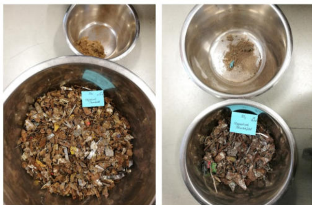
Abbildung 46: Stark magnetisierbare Eisenprodukte des Nass- (links) und trockenmechanisch (rechts) aufbereiteten Siedlungsabfall (eigene Aufnahme).
