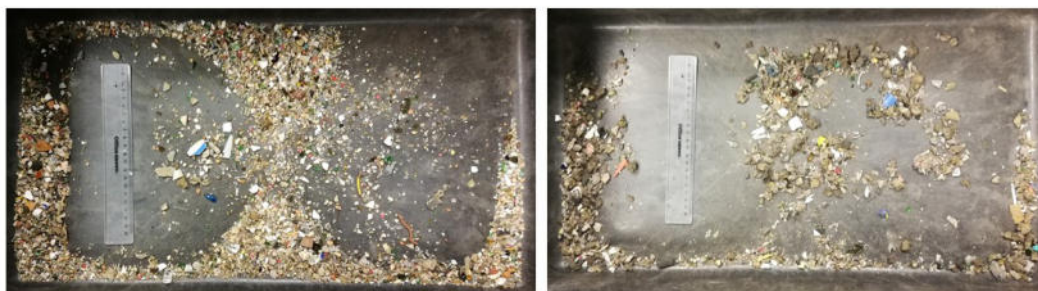
Abbildung 68: Restprodukte der Sortierschritte des nass- (links) und trockenmechanisch (rechts) aufbereiteten Siedlungsabfalls (eigene Aufnahme).
