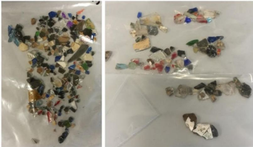
Abbildung 62: Fremdglas im Rest nach Braunglassortierung (nassmechanische Linie - links; trockenmechanische Linie - rechts).
