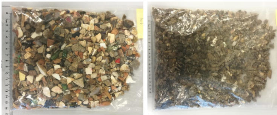
Abbildung 66: Inertprodukte des nass- (links) und trockenmechanisch (rechts) aufbereiteten Schwergutes (eigene Aufnahme).
