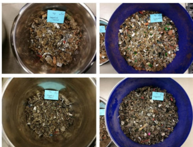
Abbildung 48: Schwach magnetisierbare Eisen-Produkte des nass- (links oben) und trockenmechanisch (links unten) aufbereiteten Siedlungsabfalls mit den Resten der Magnetscheidung (rechts) (eigene Aufnahme).
