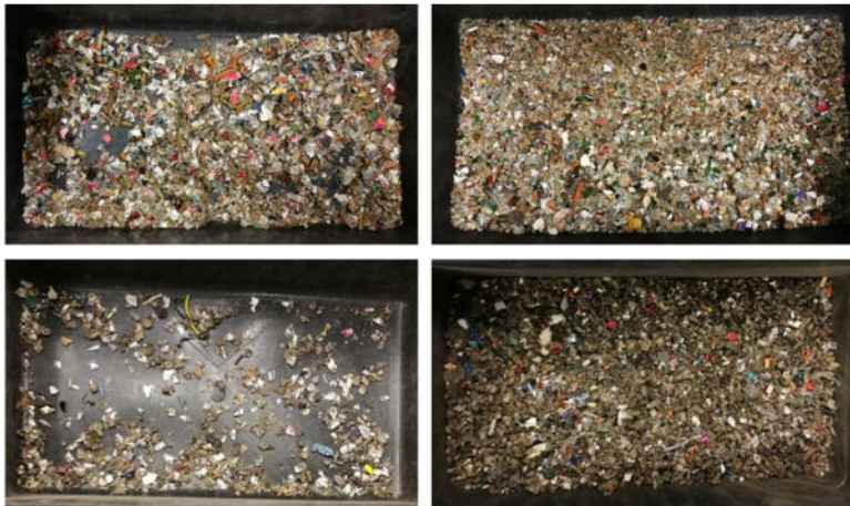
Abbildung 50: NE-Metallprodukte (links) der Nass- (oben) und trockenmechanisch (unten) erzeugten Schwergutfraktion mit den Resten (rechts) (eigene Aufnahme).
