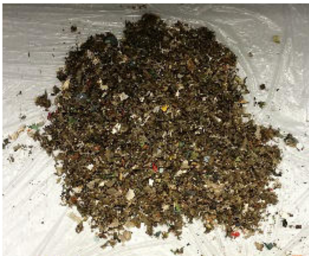
Abbildung 41: Zerkleinerter gemischter Siedlungsabfall (eigene Aufnahme).
