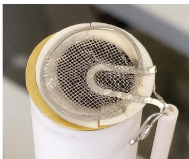
**Abb. 5-6 – Zellbruch der Zelle 02: Im eingebauten Zustand nach Messversuch**
