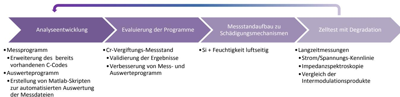
**Abb. 4-6 – Fließschema zum Ablauf der Zustandsüberwachung mittels IMA**
