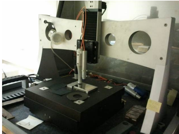
Abbildung 10: Konfokales Weißlichtmikroskop MicroProf® (chromatisch kodierter, konfokaler Punktsensor).
