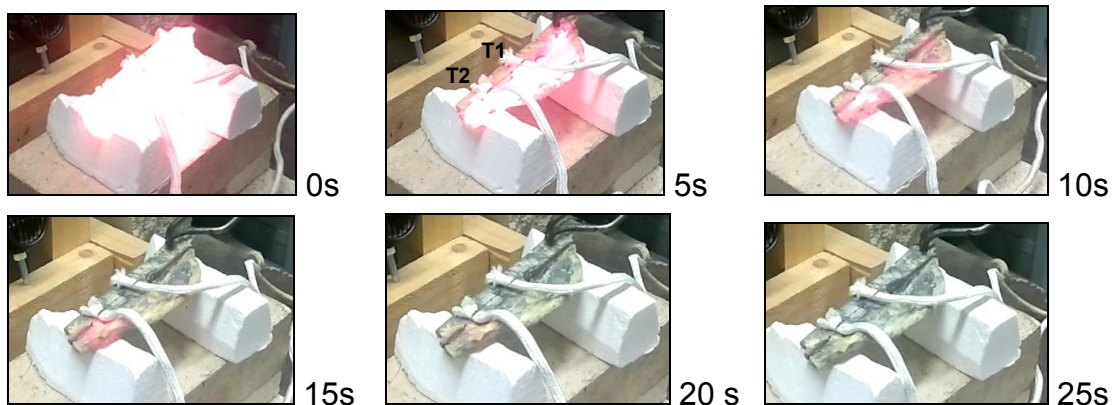
Abb. 4.26: Glühverhalten des Schaufelgrats bei 0s bis 25s nach der Ofenentnahme.
