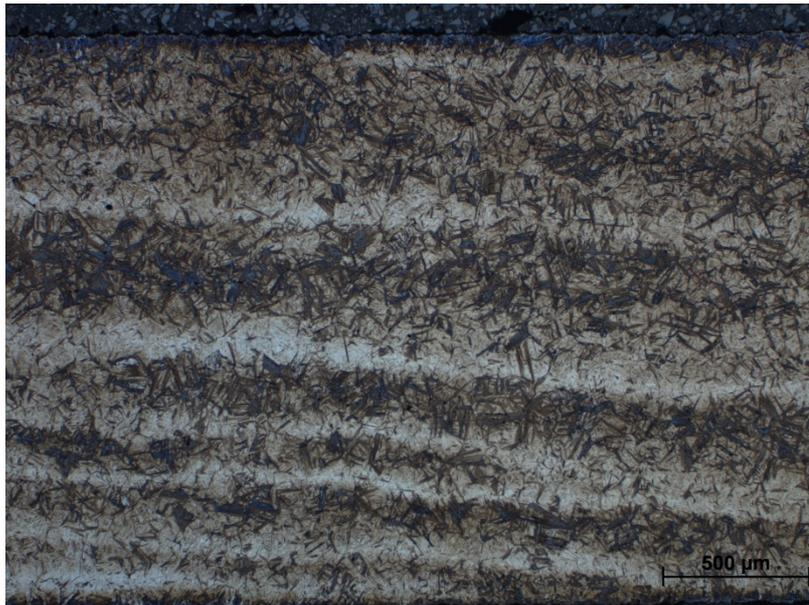
**Abbildung 6.18** Schliff Dilatometerprobe;  $\lambda=1,5$ ; Nitalätzung. Die Zeiligkeit des Gefüges entsteht durch Seigerungen während des Gusses, die durch das Schmieden verstreckt werden
