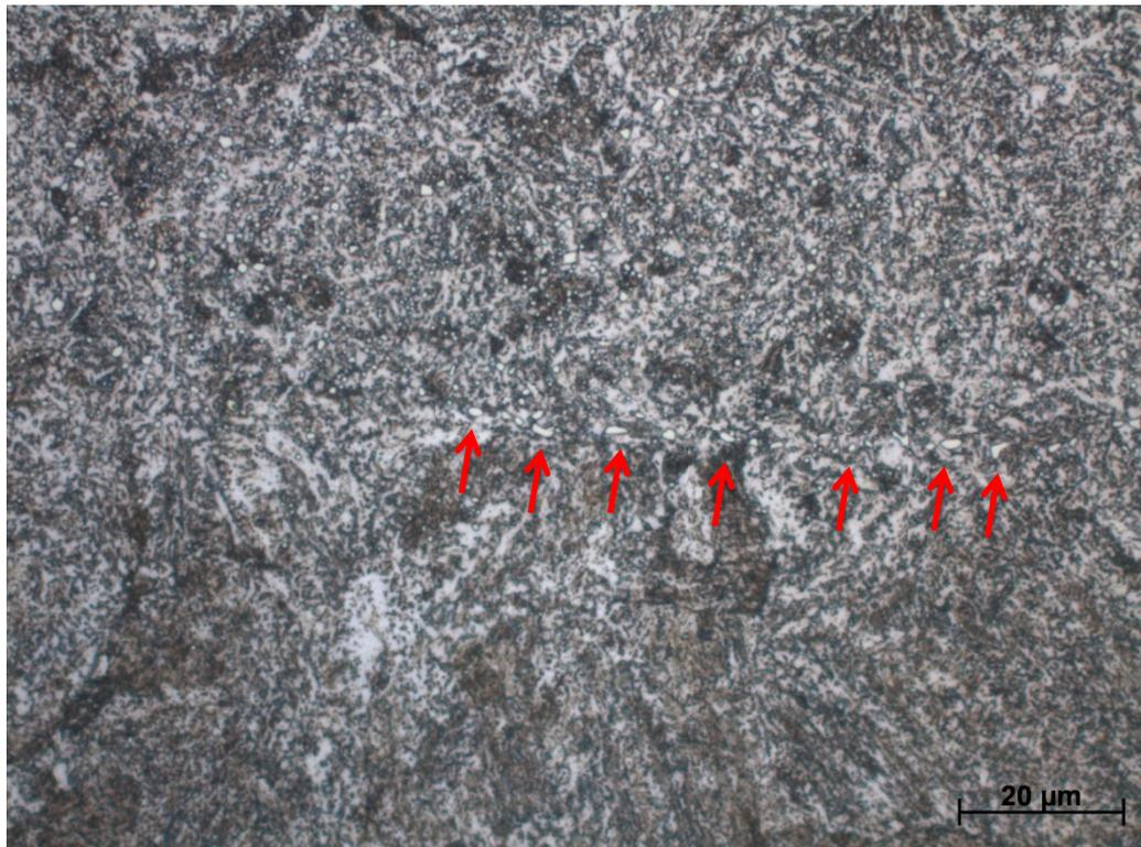
**Abbildung 6.20** Schliff der angelassenen Kerbschlagprobe;  $\lambda=20,0$ ; Nitalätzung. Die roten Pfeile zeigen die in einer Linie angeordneten Ausscheidungen, ähnlich der Ausscheidungen in den Schlifften der Versuchskurbelwellen
