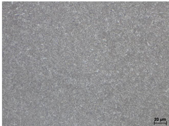
**Abbildung 6.6** Wärmebehandlung 1; Probenlage Rand; Nitalätzung. Es liegt ein sehr feines martensitisches Gefüge vor
