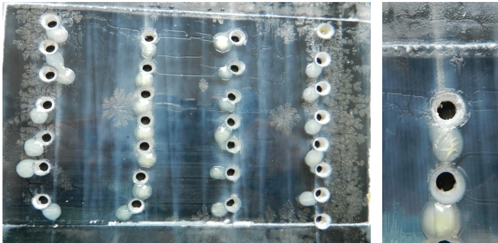
Abbildung 81: Modellisolation (11 halbüberlappt gewickelte Glimmerbandlagen und 2 AGS-Lagen) nach der Aushärtung bei 140°C
