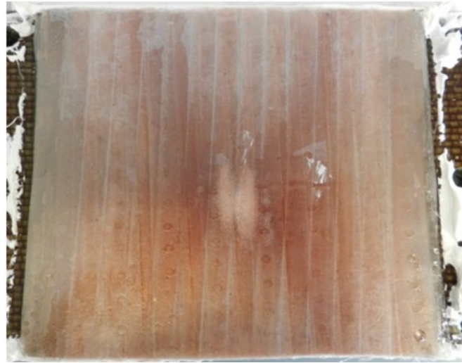
Abbildung 61: „Perforiertesplatte4“ nach Tränkung im Laborautoklaven
