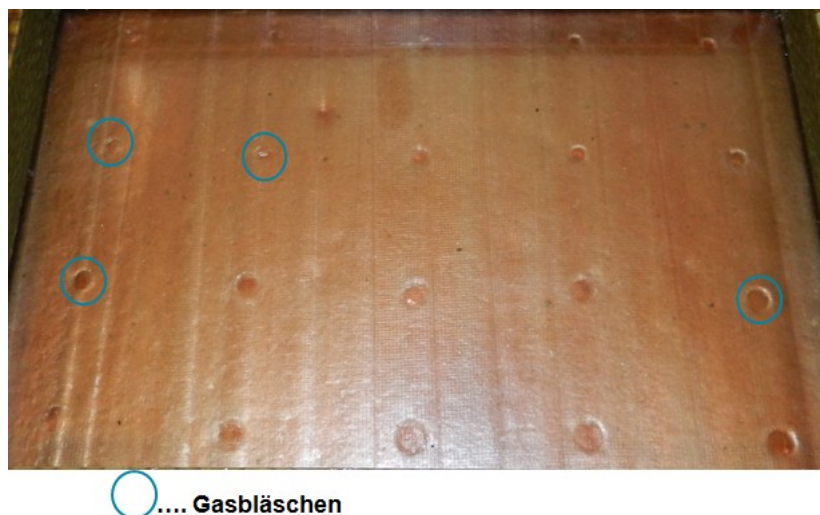
Abbildung 58: „Gelocht4“ - nach der Tränkung, nicht ausgehärtet
