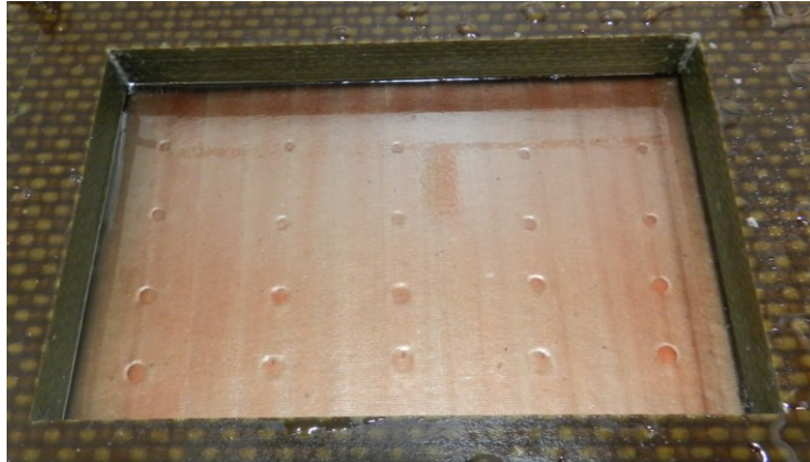
Abbildung 37: Versuchskörper mit gelochten Glimmerbandlagen
