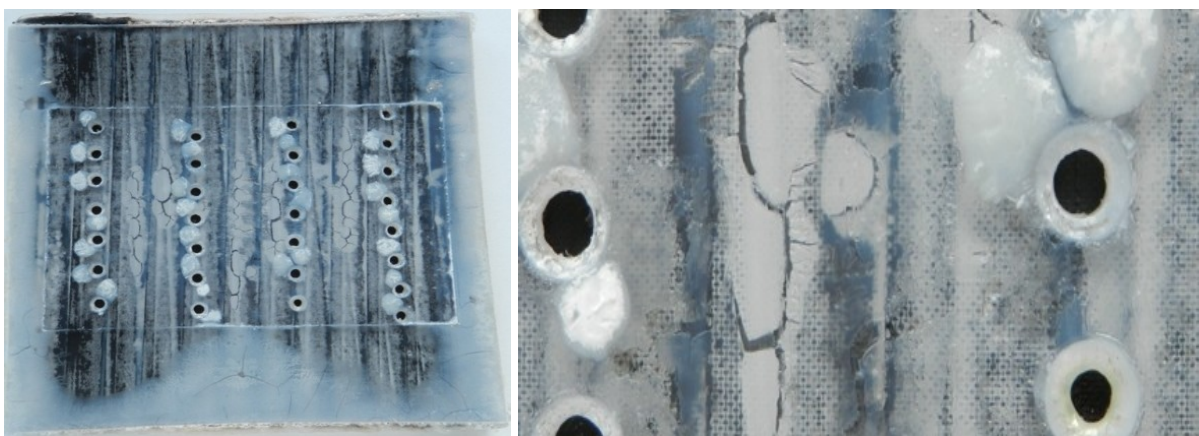
Abbildung 80: Modellisolation (12 halbüberlappt gewickelte Glimmerbandlagen und 1 AGS-Lage) nach der Aushärtung bei 140°C
