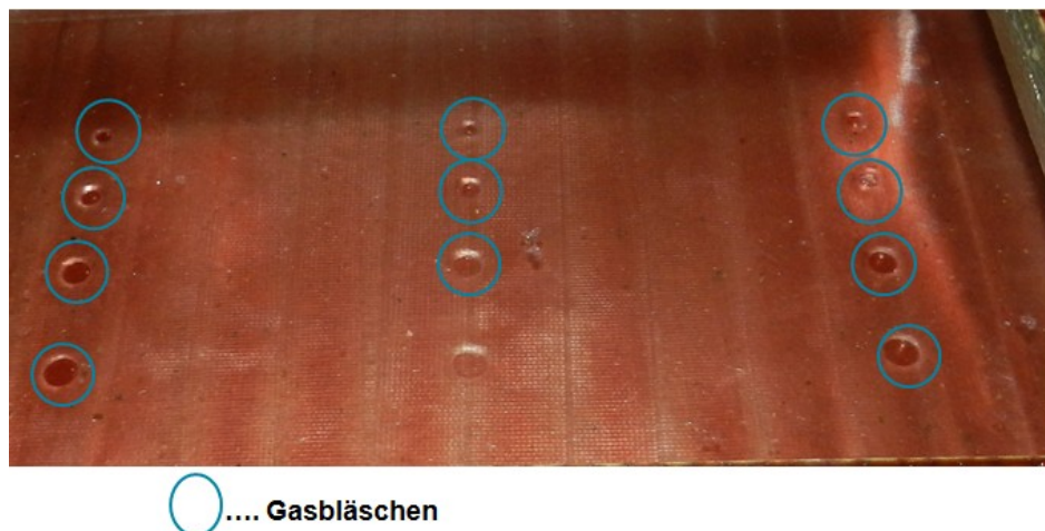
Abbildung 56: „Gelocht2“ - nach der Tränkung, nicht ausgehärtet
