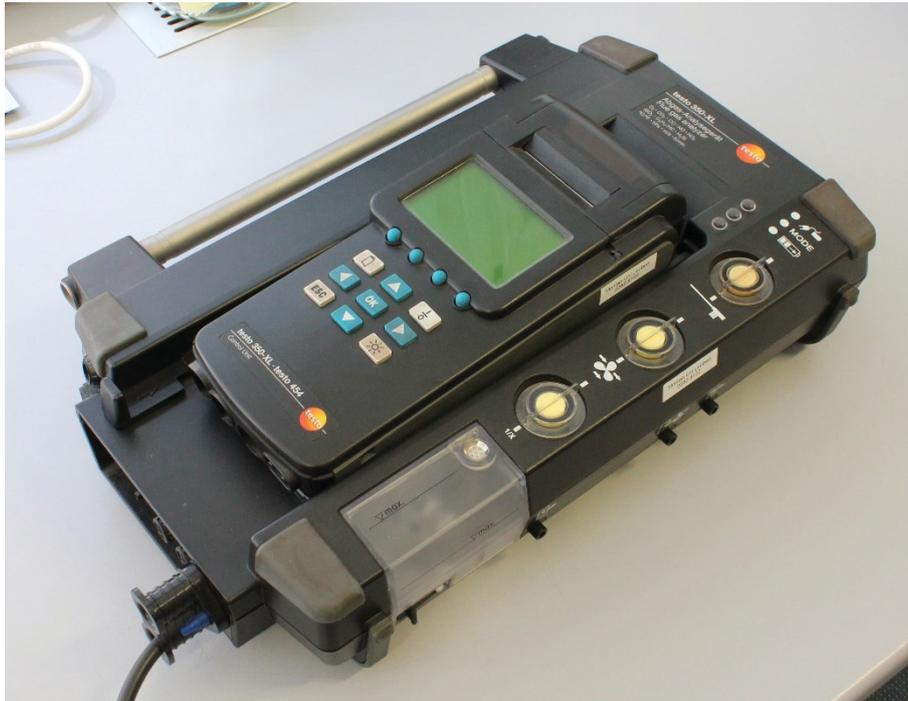
Abbildung 26: Gasmessung – Gasmessgerät (testo 350 XL)
