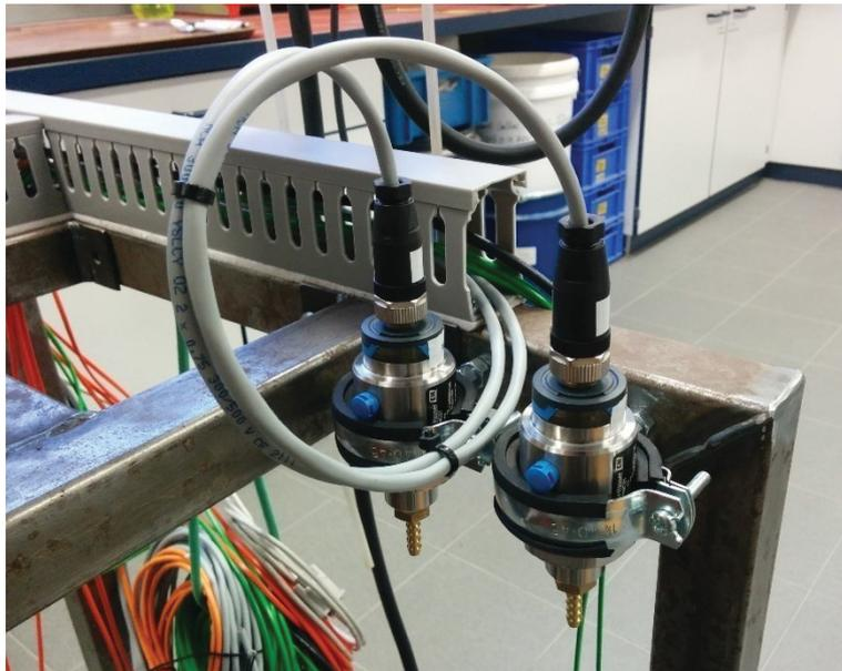
Abbildung 8: Pellet-Pot – Drucksensoren
