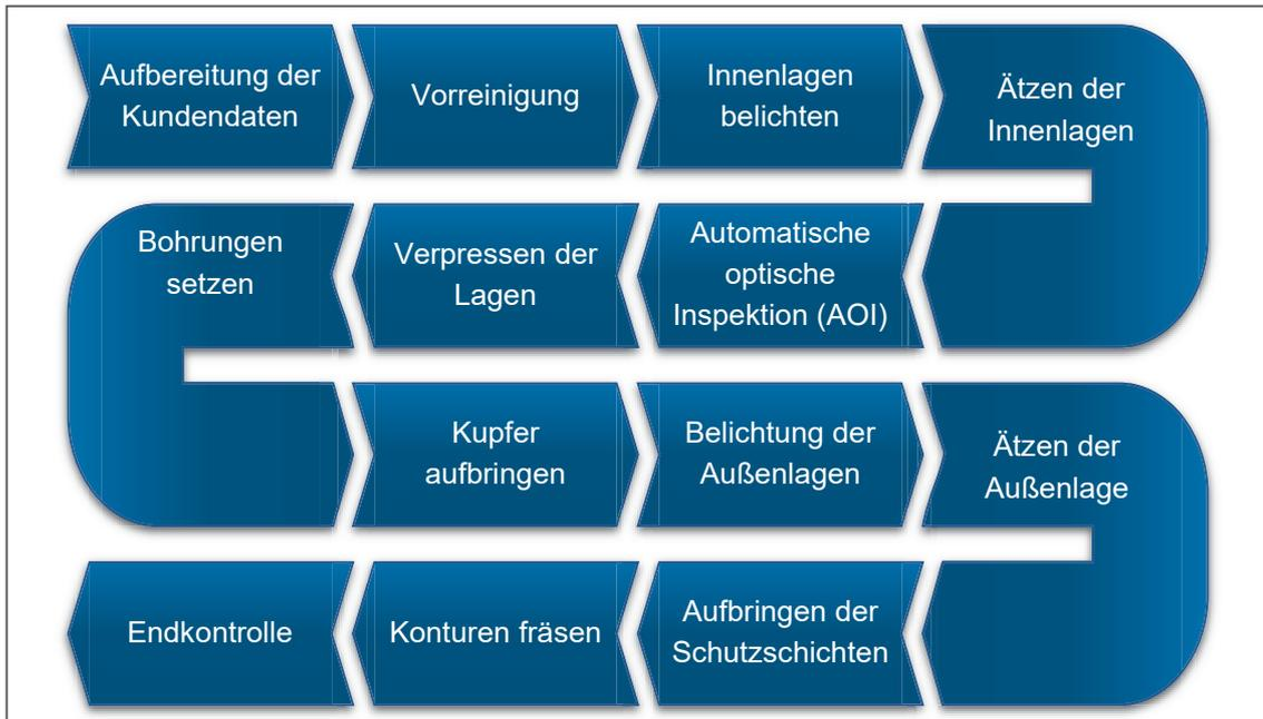
**Abbildung 2: Vereinfachter Produktionsprozess von Leiterplatten<sup>4</sup>**
