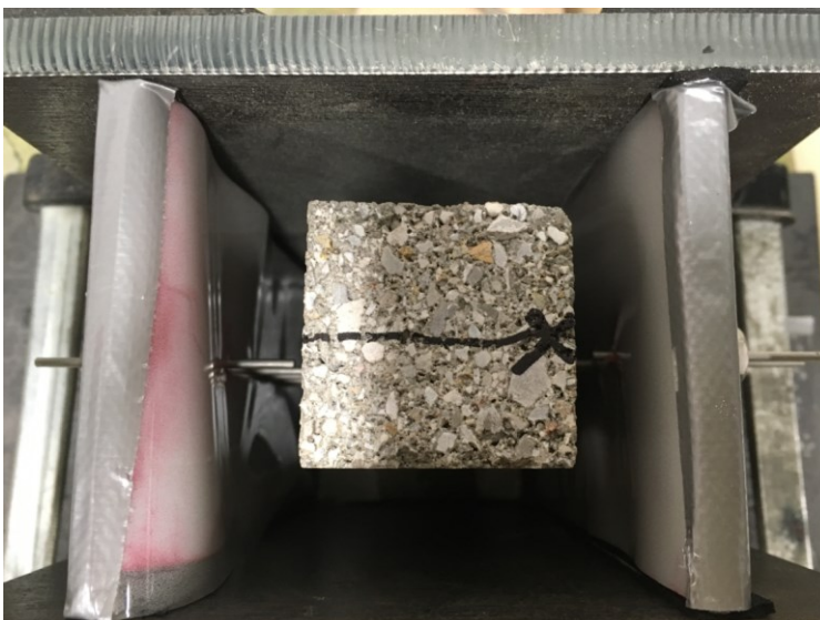
Abbildung 76: Modellfeste in Stahlrahmen
