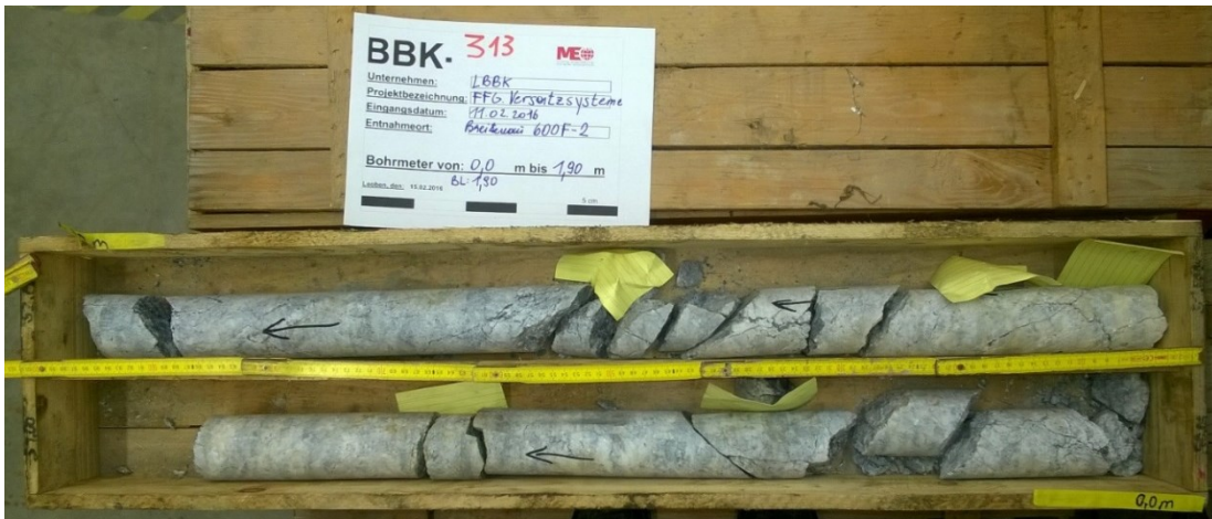
Abbildung 37: Bohrkern aus der Strecke F – Bohrloch F-2 (Feste F)
