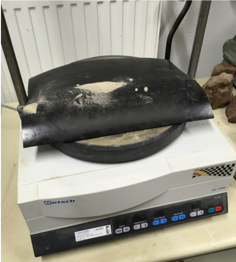
Abbildung 78: Siebmaschine zum Verdichten des Versatzmaterials
