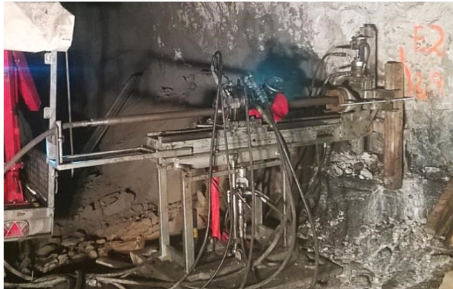
Abbildung 35: Kernbohrgerät Sandvik DE110
