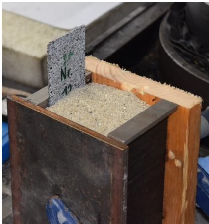
Abbildung 136: Versuchsaufbau einer Gesteinsplatte unter Einfluss der Verfüllung (Set-up 2)
