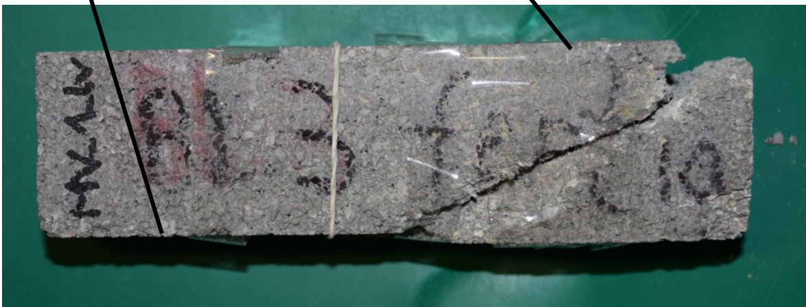
Abbildung 108: Modellfeste in Iv nach Versuch
