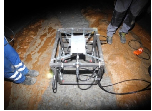
Abbildung 51: Position der eingebrachten Druckmessrahmen im Abbaufeld (links) und eingebrachter Rahmen (rechts)
