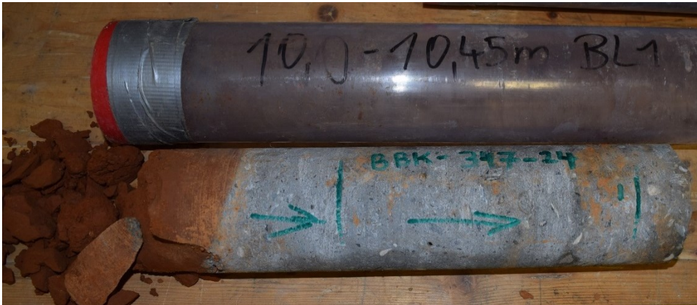
Abbildung 48: Grenze zwischen Filterkuchen und Versatz
