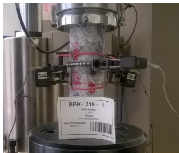
Abbildung 36: In der hydraulischen Prüfpresse eingespannte Probe
