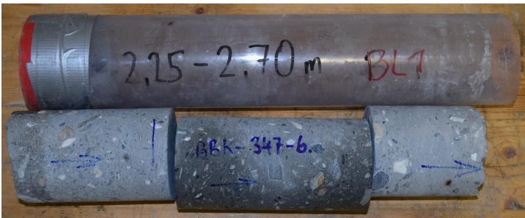
Abbildung 47: Probe 347-6 vor und nach dem Zuschnitt (Kammer C)
