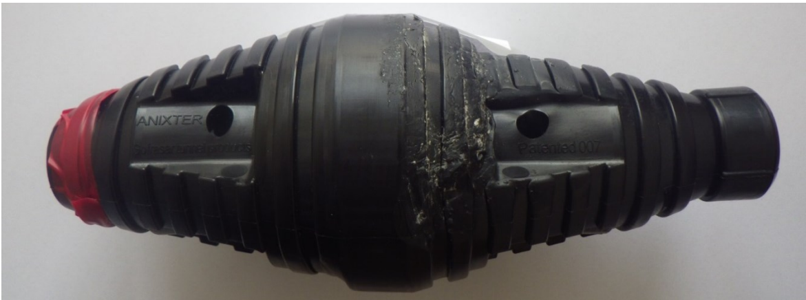
Abbildung 44: Asymmetrisch abgenützter Dübel
