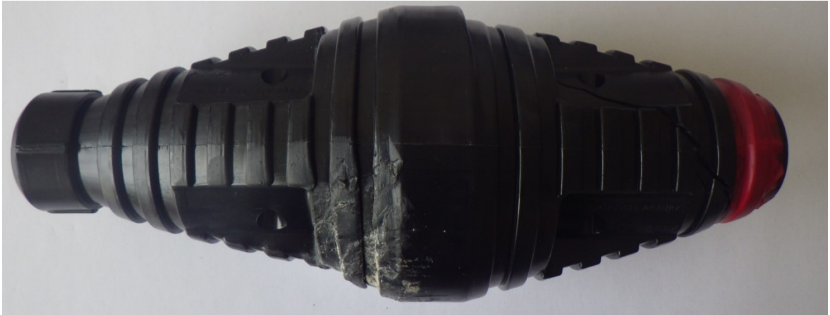
Abbildung- Anhang 29: Dübel der Probe SD_080415_P04_WB
