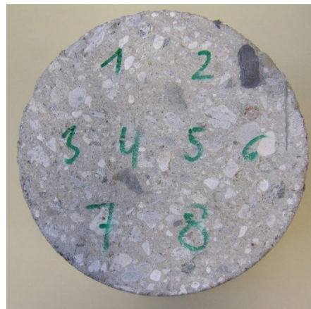
Abbildung 26: Probenoberfläche für Schmidthammerversuche- Teststellen
