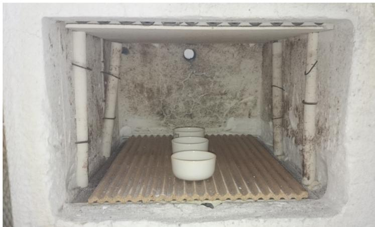
**Abbildung 32 Anordnung der Proben im Muffelofen**
