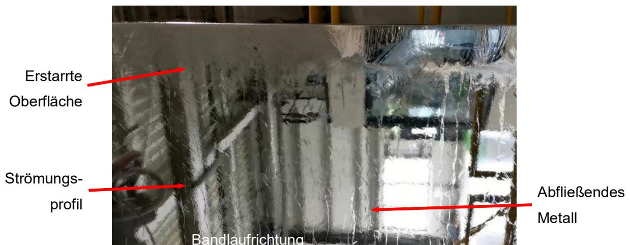
Abbildung 48: Aufnahme der Bandoberfläche direkt unterhalb der Kühlstrecke
