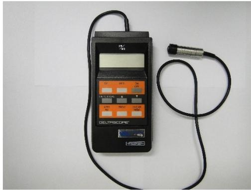
Abbildung 34: Das magnetinduktive Messgerät DELTASCOPE MP38/GA2H von Fischer
