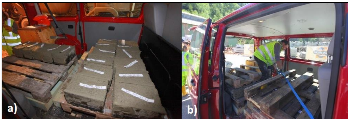
Abbildung 11a) frische Proben auf Europoolpalette mit untergelegter Schaumstoffmatte. b) Sichern der Proben durch Auflegen weitere Europoolpaletten und Spanngurte
