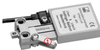
Abbildung 18 Dehnungsaufnehmer mit ①: Verriegelung der Messung [10].
