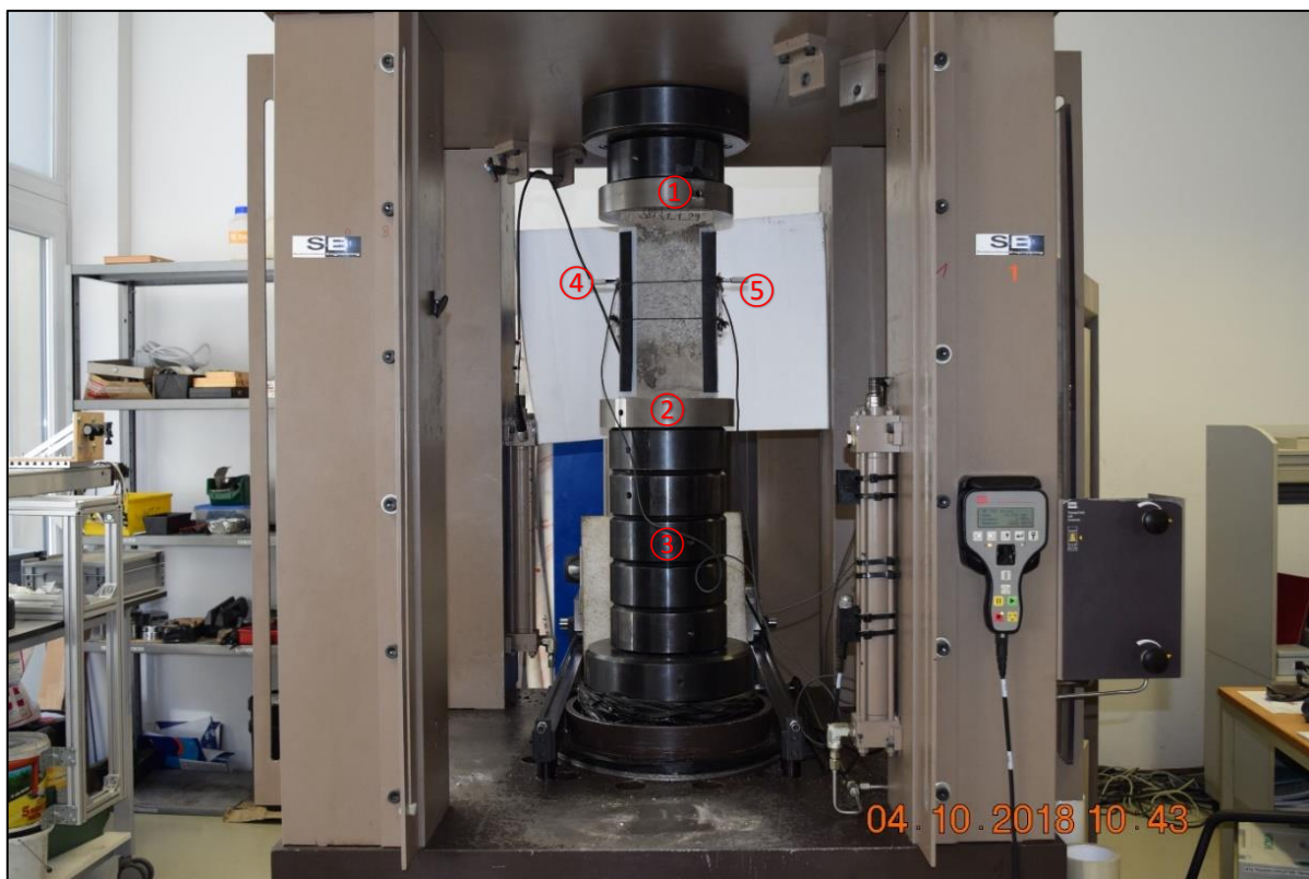
Abbildung 19 Aufbau der Gesteinsprüfpresse für den einaxialen Druckversuch mit eingebauter Probe. ①: obere Druckplatte ②: untere Druckplatten, ③: 5 Beilagplatten für passenden Abstand der Druckplatten, ④: Dehnungsaufnehmer 1, ⑤: Dehnungsaufnehmer 2.
