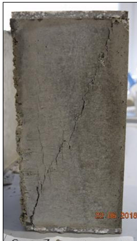
Abbildung 49 Bruchbildung des Probekörpers 17 aus der Serie 1 vom ZaB 48 Stunden nach der Herstellung der Probe.
