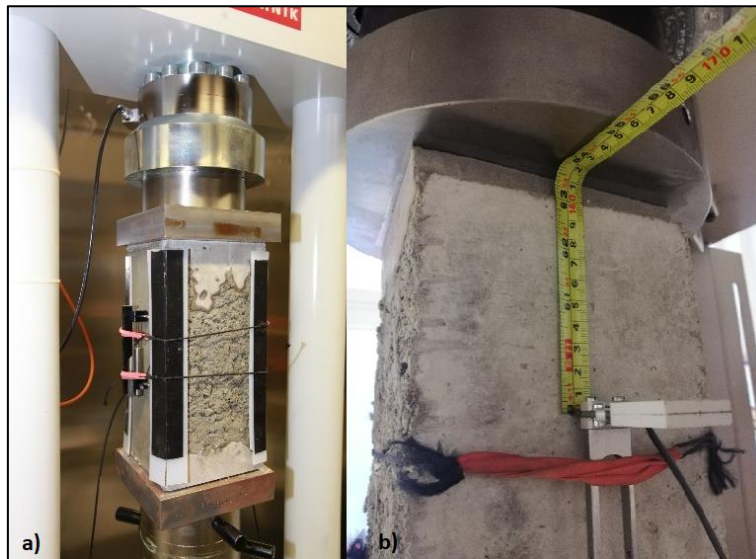
Abbildung 21a: Eingebaute Probe in der Langzeitversuchsanlage mit Dehnungsaufnehmern und Kantenschutz. b) zentriertes Positionieren des Dehnungsaufnehmers auf der rechten Seite der Probe (10 cm unterhalb der Kontrastlinie Spachtelmasse und Spritzbeton).
