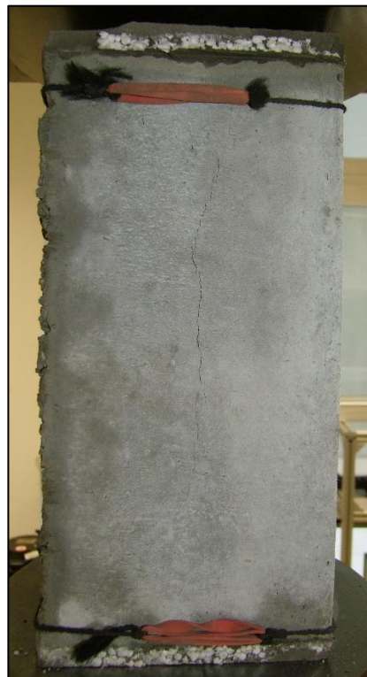
Abbildung 51 Bruchbildung nach Versuch der Probe 20 aus Serie 3 vom SBT 120 Stunden nach der Herstellung
