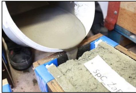
Abbildung 14 Eingießen der Schnellspachtelmasse in den freien Raum zwischen Überschalung und Probe.
