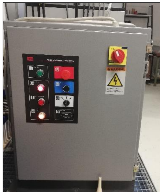
Abbildung 22 Hydraulik mit Einschaltknopf rechts oben (rot) und blauer „Reset“-Taste für das Zurücksetzen.
