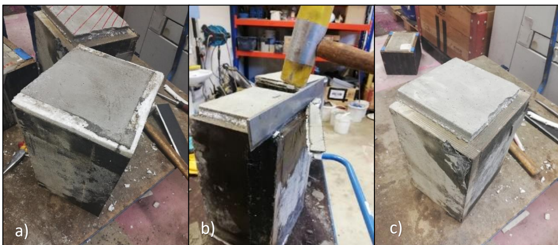
Abbildung 15 a) angehefteter Styroporstreifen an ausgehärteter Schnellspachtelmasse. b) Abtrennen der Styroporstreifen vom U-Profil der Probenschalung mittels Hammer und Abziehwerkzeug. c) gesäubertes U-Profil nach Abtrennen der Styroporstreifen.
