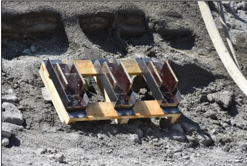
Abbildung 5 Probenhaltevorrichtung mit 3 Halterungen für die U-Profilschalungen aus Siebdruckplatten.
