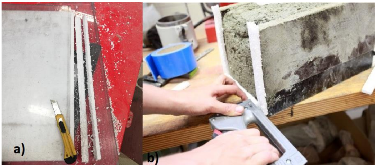
Abbildung 12a) Zurechtschneiden der Styroporstreifen (ca. 10 mm breit). b) Anbringen der Styroporstreifen an das U-Profil der Schalungen.
