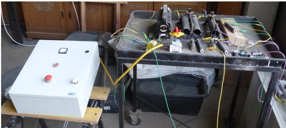
**Abbildung 98: Schaltschrank mit angeschlossenen Widerständen**
