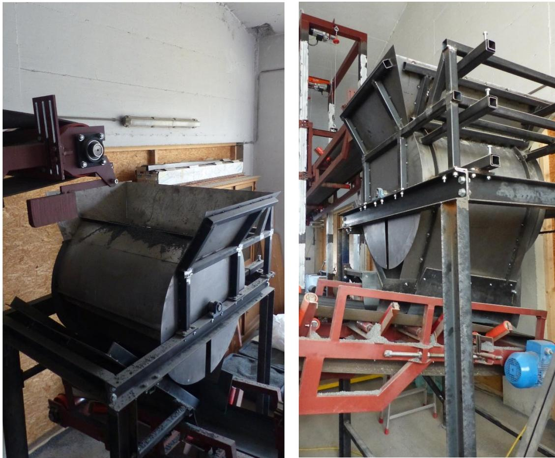
**Abbildung 97: Anordnung des Prüfstandes im Förderkreislauf**
