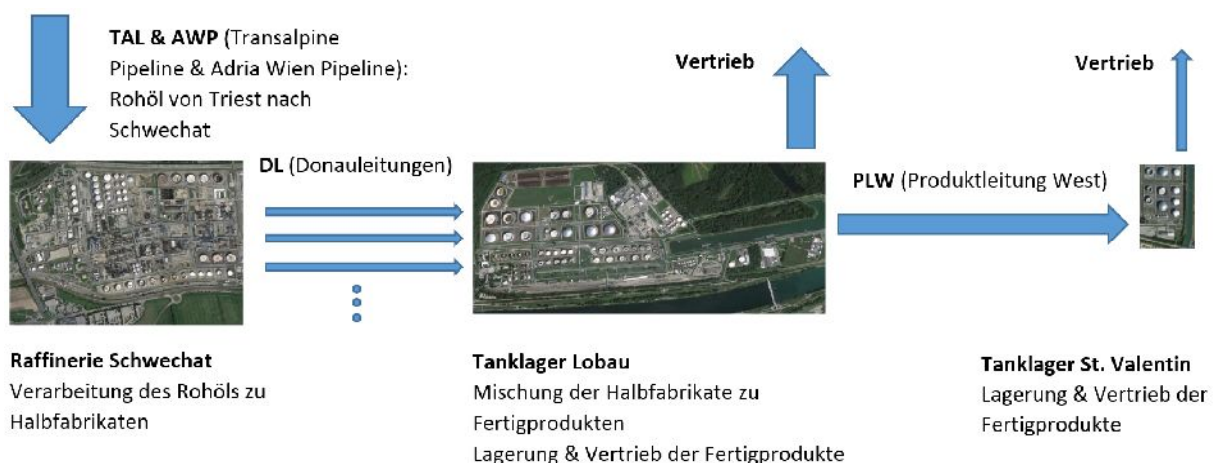
Abbildung 19: Prozesskette von Rohöleingang bis zum Verkauf der Fertigprodukte
