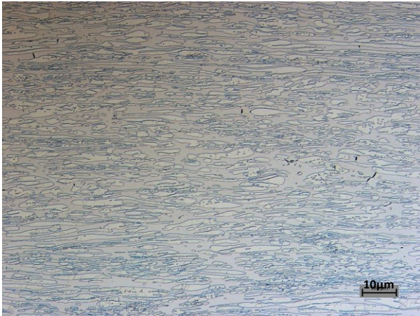
Abbildung 46: Gefügebilder des Stufenstauchversuchs nach den Umformparametern von Tabelle 2 mit 100facher Vergrößerung.
