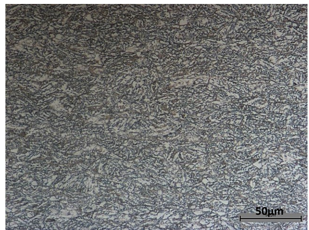
Abbildung 67: Gefügebild von der Blechmitte des Vergütungsstahls mit den Umformparametern aus Tabelle 12 und einer Ofentemperatur von 980 °C.
