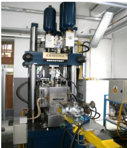
Abbildung 34: Gesamtaufnahme des servohydraulischen Umformsimulators am Lehrstuhl für Umformtechnik
