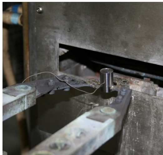
Abbildung 35: Probenhalterung am Manipulator der Servotest-Anlage
