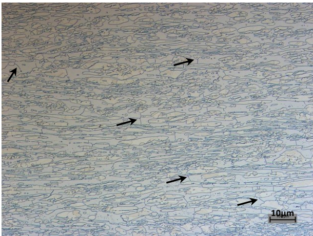
Abbildung 48: Gefügebilder des Stufenstauchversuchs nach den Umformparametern von Tabelle 2 jedoch mit \dot{\varphi} = 1s^{-1} bei 100facher Vergrößerung.
